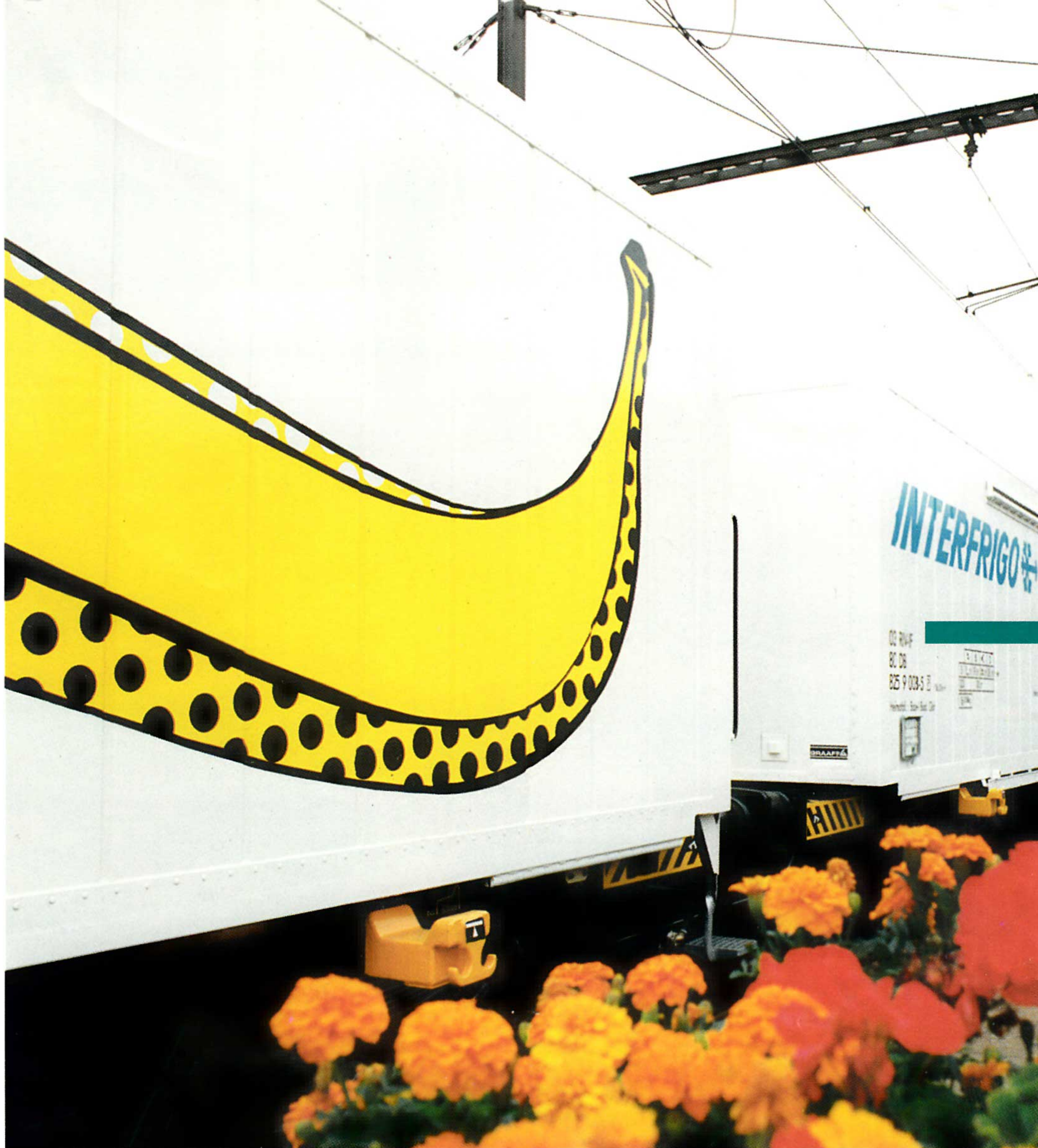
De "bananenwagen Interfrigo" (type WAI 28B) laadt tot 33 % meer bananenkartons dan zijn voorganger (de WAI 24, Serie 8258).
