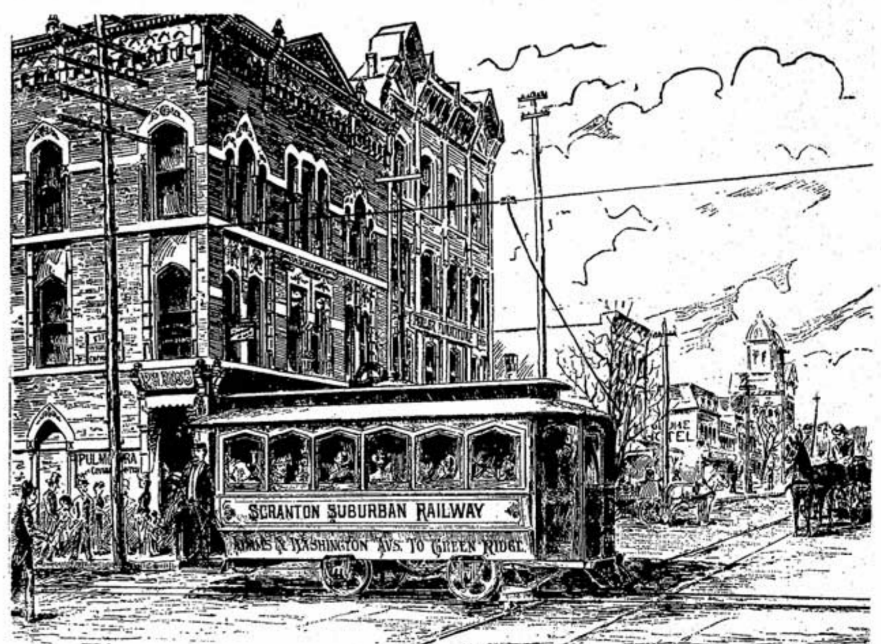
„Van Depoele's Scranton Suburban Railway”, 1886, eerste elektrische tramlijn te Scranton, Pennsylvania. Snelheid: 20 km/uur; rendement: 160 km per dag.
