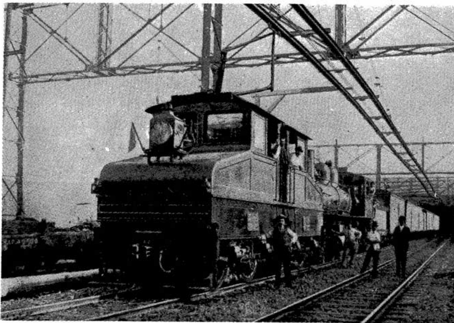
Baltimore and Ohio Railroad: Bo-Bo lokomotief, 1.440 pk voor het gebruik in de streek rond Baltimore, 1895.
