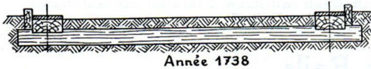
Fig. 99. — Rails en bois garnis de plaques de fonte avec rebords extérieurs en bois.
