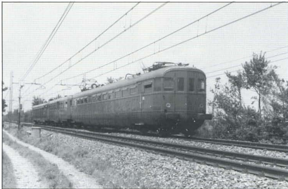
PHOTO 17-40 Un train local Parma-Bologna assuré par deux ALe 880 et d'une remorque Le 640. L'automotrice de tête présente deux faces avant plates munies de portes d'intercirculation. La dernière automotrice du type ALe 880, la 880.058, a été retirée du service au dépôt de Cremona durant l'automne 1993. Castelquelfo, 25 juin 1985.
