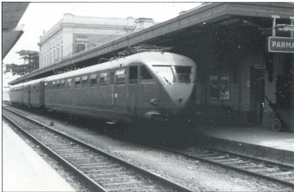
PHOTO 17-39 Un train en provenance de Bologna vient d'arriver à Parma. La rame est composée de deux automotrices type ALe 790 encadrant une remorque du type Le 640. La couleur des anciennes automotrices des FS était brun chocolat, avec une bande plus foncée en bas de caisse et la traverse de tête peinte en rouge. 25 mai 1985.
