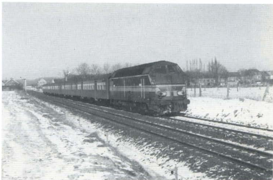
PHOTO 19-53 Au total, 46 voitures M3 furent construites de 1960 à 1962 par l'atelier central de Mechelen en deux versions : 36 voitures B (114 places assises) n° 42.801-42.836; et 10 voitures ABD (44 places A et 29B) n° 40.001-40.010. Elles étaient dérivées des M2 avec lesquelles elles se différenciaient par leurs parois latérales dépassant l'extrémité de la caisse, l'aménagement intérieur simplifié, l'emploi de bogies Pennsylvania, le chauffage uniquement à vapeur et leur vitesse limitée à 120 km/h. Les M3 ont parcouru la plupart des lignes non électrifiées des Flandres, en particulier entre Aalst-Denderleeuw-Geraardsbergen-Ath, Bruxelles-Kortrijk, Aalst-Burst, Gent-Zottegem-Geraardsbergen. Elles ont terminé leur carrière sur la relation IR Geraardsbergen-Gent-De Panne. Un train omnibus Gent-Geraardsbergen composé de 5 voitures du type M3 quitte la gare de Scheldewindeke encore pourvue à cette époque de la signalisation mécanique, 16 février 1984.
