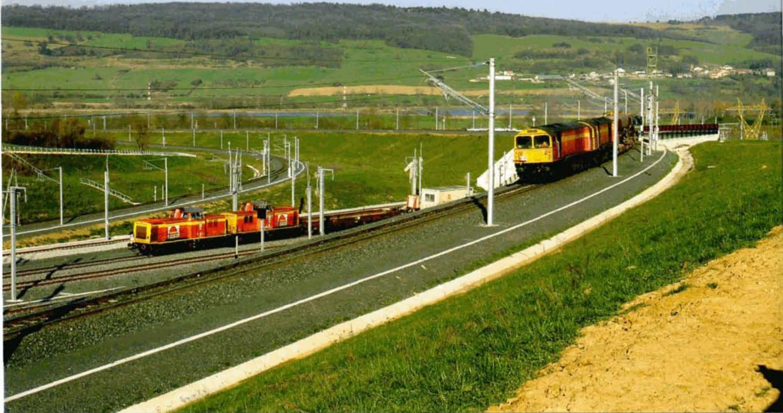
**PHOTO 74-19** A Prény se trouve la bifurcation sous forme d'un saut-de-mouton, vers Pagny-sur-Moselle et Metz ou Nancy. A gauche, un train de travaux SECO-Rail, remorqué par deux locomotives Diesel ex-211 de la DB, circule à contre-sens sur la voie Paris - Strasbourg de la LGV. A droite, sur le saut-de-mouton, un train de ballast est tracté par les 58009 et 58040 de SECO-Rail. Il s'agit de machines de la Class 58 anglaise louées à EWS.
