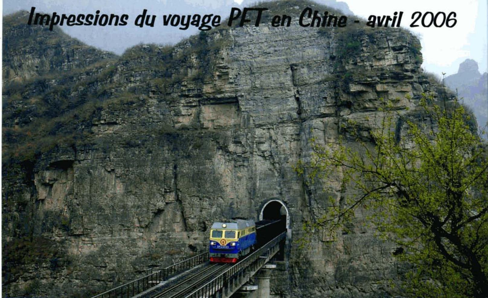
**PHOTO 74-12** Située non loin de Péking, la ligne de JingYuan est particulièrement spectaculaire. Le 17 avril, un train de charbon remorqué par la DF4D-4020 franchit un viaduc coincé entre deux tunnels à Shidu. La famille des CC du type DF4 compte près de 10.000 locomotives ! Les DF4D construites depuis 1996, développent 2940 kW (4000CV), pour une masse de 138 t. PFT.
