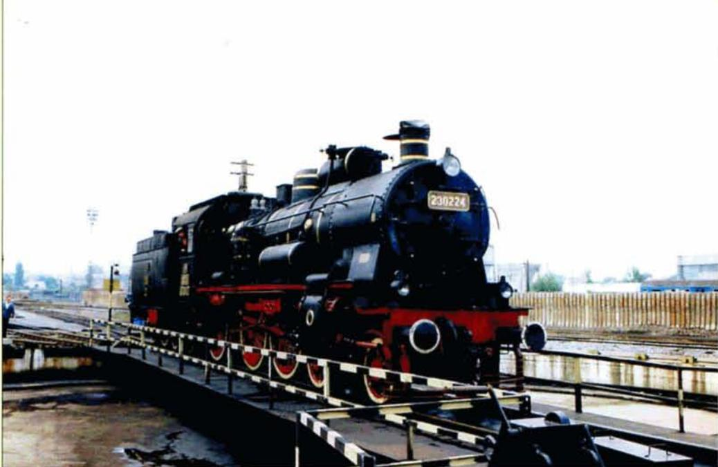
La 230.224 des CFR, sur la plaque tournante du dépôt de Sibiu, en août 1997. Cette locomotive fut construite en Roumanie en 1933 par *Resita* (n° de construction 231); elle est préservée en état de marche au dépôt de Brasov. Charles DE COSTER.
