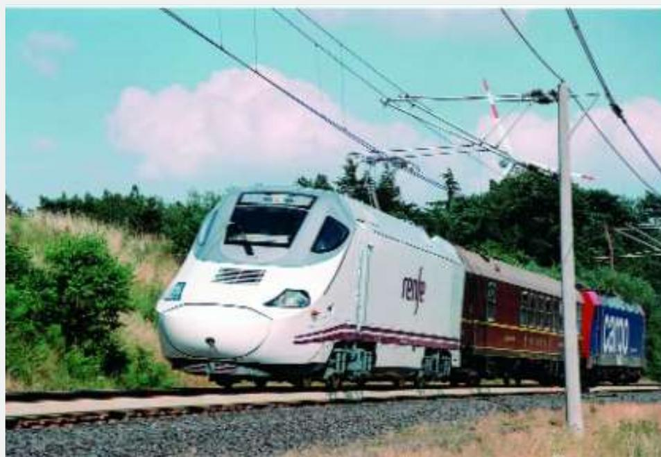
**La première des 44 nouvelles motrices, la S 130 001, en cours d'essai sur le circuit de Wil-denrath. La Re 484 005 de CFF Cargo est accouplée en queue afin de servir de poids-frein.**
