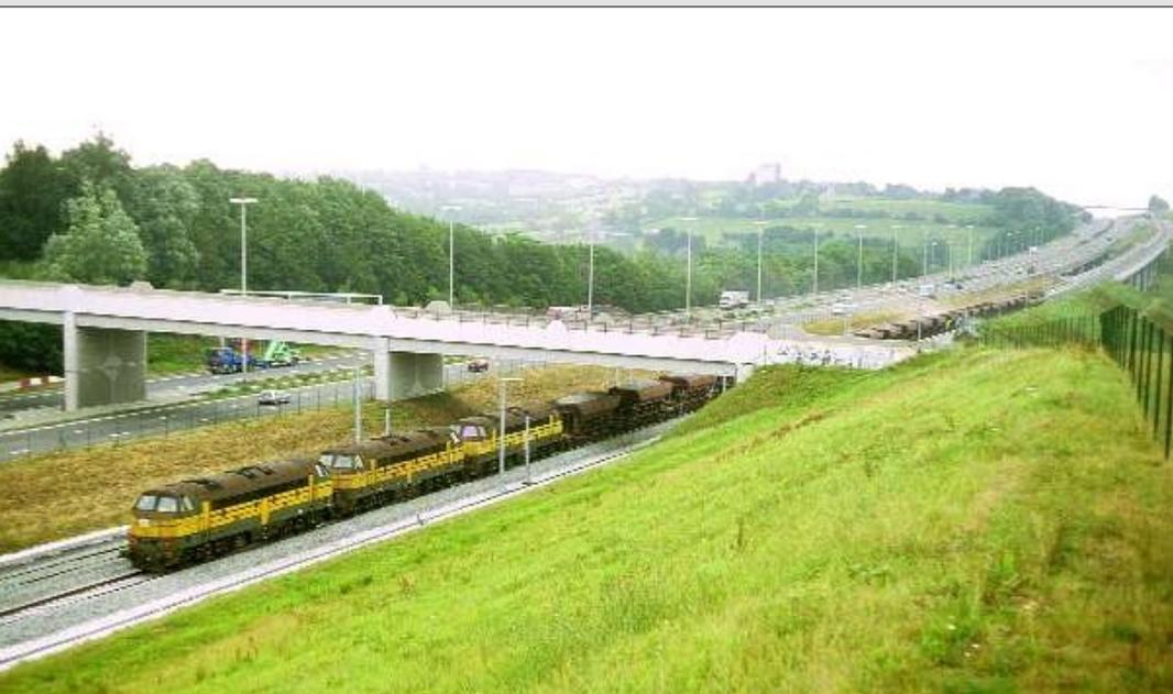
***Sur les deux vues suivantes, on voit fort bien la forte rampe de la L3. Pas moins de cinq machines sont nécessaires pour remorquer ces trains. Ci-contre, dans les environs de Micheroux, le 13 juillet. Ci-dessous, le 11 août, sur le viaduc de Herve. Le train roule en direction de l'Allemagne, mené par la 5401.***
