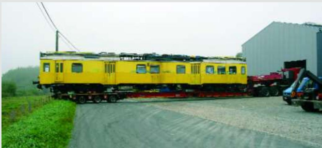
**PHOTO 76-31** ↗ *Le convoi routier était coincé entre l'atelier CML et une prairie. Sortir de cette position semble impossible. Pourtant, en deux manoeuvres, le camion était sur la route, grâce à la possibilité de faire virer les roues arrière de la remorque.*
