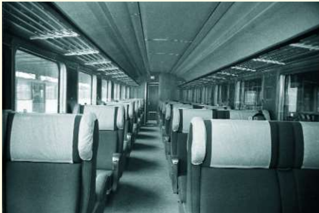
PHOTO BD-247 Vue intérieure de la voiture coach à couloir central d'une rame hollando-suisse, d'une capacité de 42 places. Il s'agit de la voiture pourvue d'un poste de conduite. Bruno DEDONCKER, collection PFT ©.
