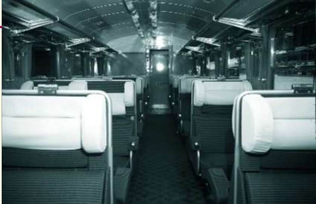
PHOTO BD-250 Vue intérieure de l'aménagement des rames RGP TEE de la SNCF. Chaque voiture ne comportait qu'un seul grand compartiment du type coach à couloir central de 39 places (voiture-motrice) ou 42 places (remorque-pilote). Bruno DEDONCKER, collection PFT ©.
