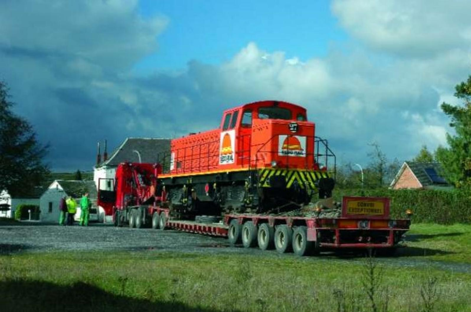
**PHOTO 83-52 ↑ - PHOTO 83-53 ↓** Le 30 octobre 2007, arrivée devant la gare de Momignies de la seconde DE 600 SECO-RAIL. Elle sera déchargée à l'aide de deux grues routières. Les Houillères du Nord et du Pas-de-Calais possédaient 109 locomotives de ce type, mises en service entre 1958 et 1963, d'une puissance de 600 CV (825 CV pour 10 machines équipées d'un moteur Diesel suralimenté).
