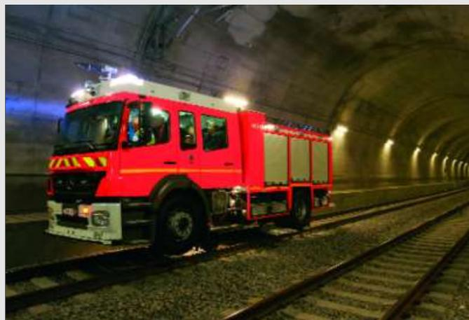
Deux camions auto-pompes «rail-route» peuvent intervenir directement au cœur du tunnel. Ces véhicules possèdent une réserve d'air pour garantir le fonctionnement du moteur et pour l'équipe d'intervention. Photo *Infrabel*, 31 octobre 2007.
