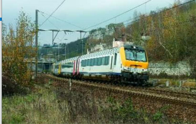
**PHOTO 83-31** Une tournée d'inspection des caténaires sur l'ensemble du réseau a été menée par la 1341 munie de pantographes adaptés pour l'occasion. La rame utilisée était formée de la voiture de mesure ES800 accouplée du côté de la 1341, et deux voitures I11 dont une pilote afin de permettre à ces parcours de circuler en réversibilité, ce qui est une première. Le 19 novembre 2007, passage à Beez d'un parcours Schaerbeek - Visé via Namur et Liège. Christian AUQUIERE.
