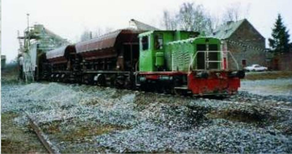
En 1955, les locomotives à vapeur furent remplacées par trois locotracteurs *Cockerill* semblables aux 91 de la SNCB (à l'époque type 230). Numérotés 2 à 4 aux CUP, ils portaient les numéros de construction 3504 à 3506
