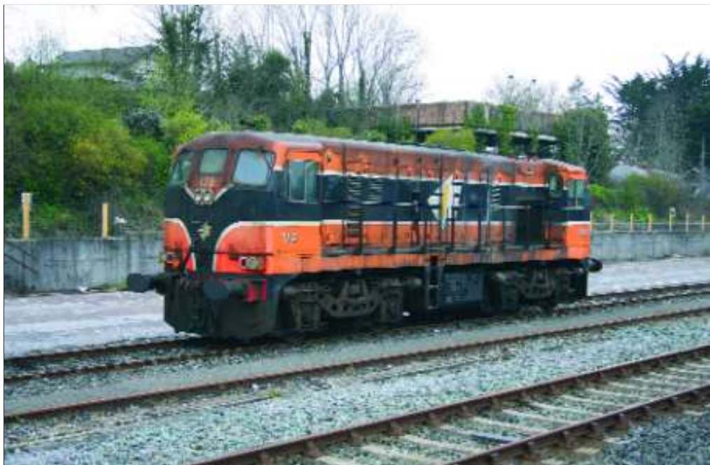
PHOTO 89-43 La Bo'Bo' 170 garée à Mallow le 18 avril 2008. Cette locomotive, aujourd'hui démolie, faisait partie d'une série de 37 machines (141 à 177) construites par GM de 1962 à 1963. Elles sont équipées d'un moteur GM type 567CR de 8 cylindres de 709 kW. Masse totale : 67 t. A la mi-octobre 2008, il subsistait 12 machines de cette série en service. Philippe DE GIETER.
