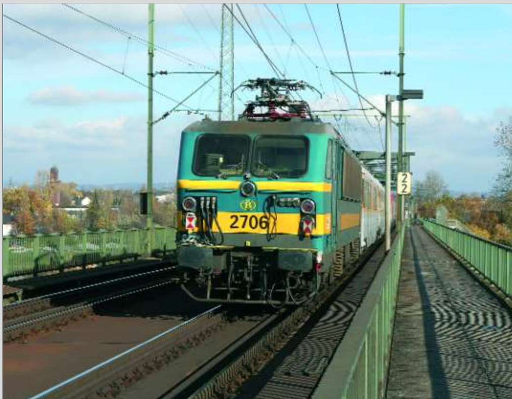
Une vue prise à Mainz le 8 novembre 2008, lors du retour vers München de la 2706 pour le démontage du pantographe Schunk . Ce pantographe est fixé très haut sur la toiture, ce qui donne l'impression qu'il touche la caténaire ! Nicolas VILLENAVE.
