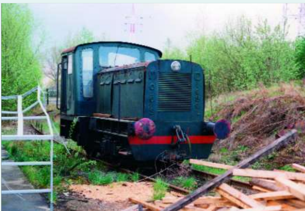
↑ Les deux autres locotracteurs sont hors service depuis longtemps; ils ont été construits par Moës à Waremme. Le premier était du type LNDC4, d'une puissance de 68 CV et d'une masse de 16 t. Luk GIBENS, 1996.
