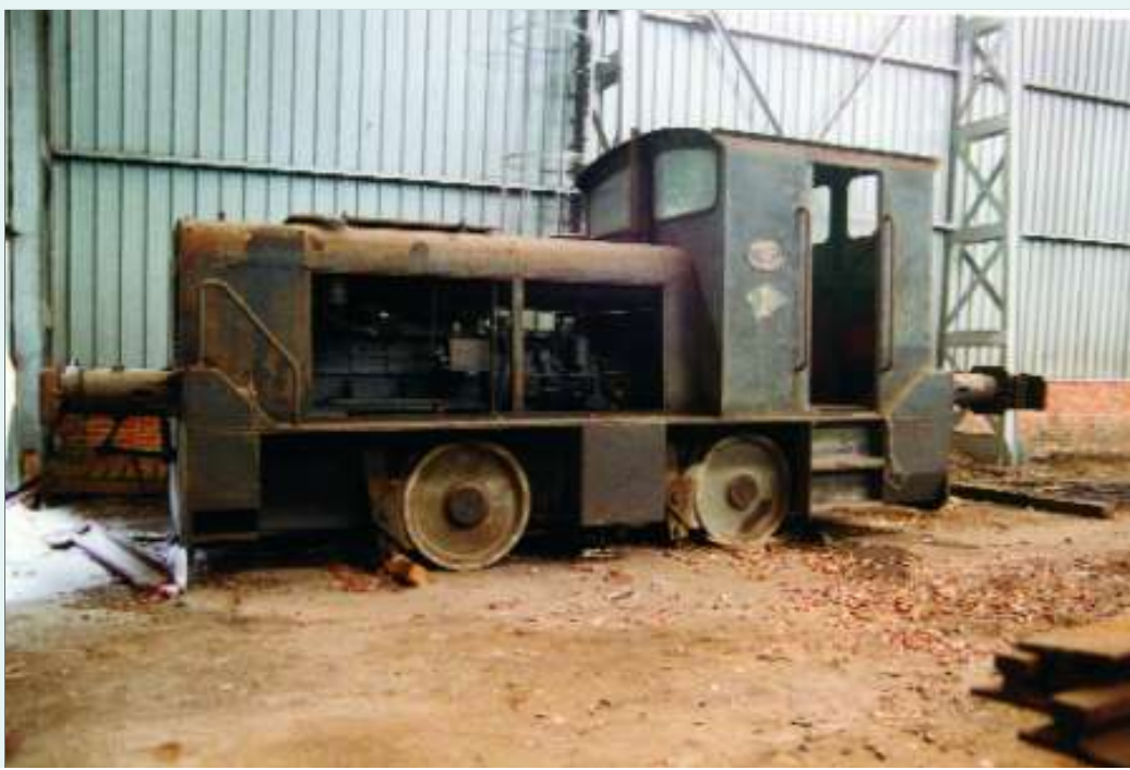
↑ Les deux autres locotracteurs sont hors service depuis longtemps; ils ont été construits par Moës à Waremme. Le premier était du type LNDC4, d'une puissance de 68 CV et d'une masse de 16 t. Luk GIBENS, 1996.
