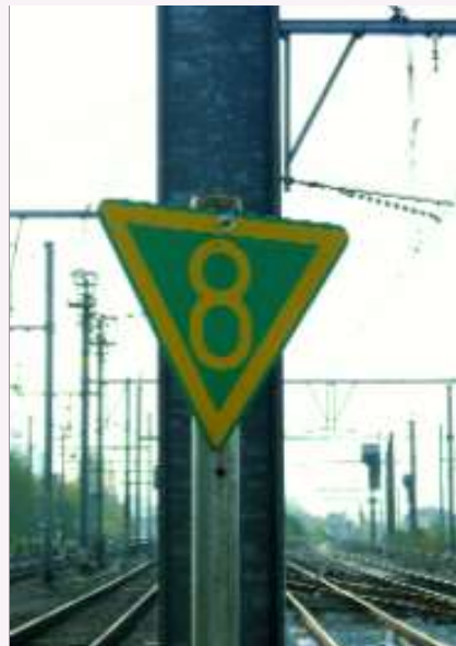
Un panneau de vitesse de fin de zone, jaune à bord vert, implanté à la sortie de la gare de Schaerbeek en direction de Bruxelles-Midi. Un mouvement venant d'un itinéraire où la vitesse était inférieure peut relever sa vitesse à celle indiquée par le panneau.
