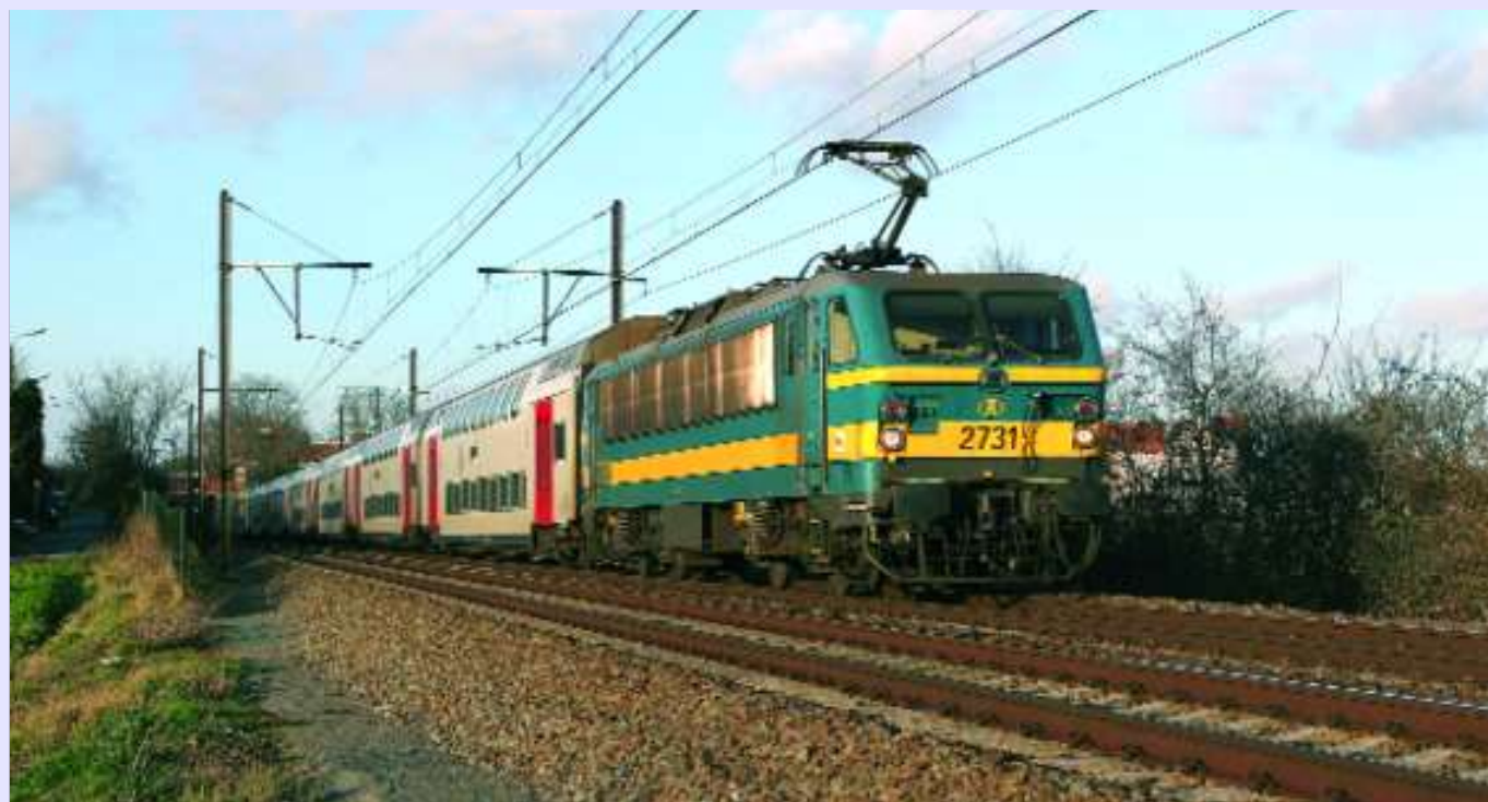
PHOTO 89-68 Depuis le 16 novembre, c'est le pantographe avant qui est levé sur les locomotives monocourant 3 kV équipées de deux pantographes. IC I 2035 Antwerpen-Centraal - Charleroi-Sud, Holleken, 19 décembre 2008. Jean-Luc VANDERHAEGEN.
