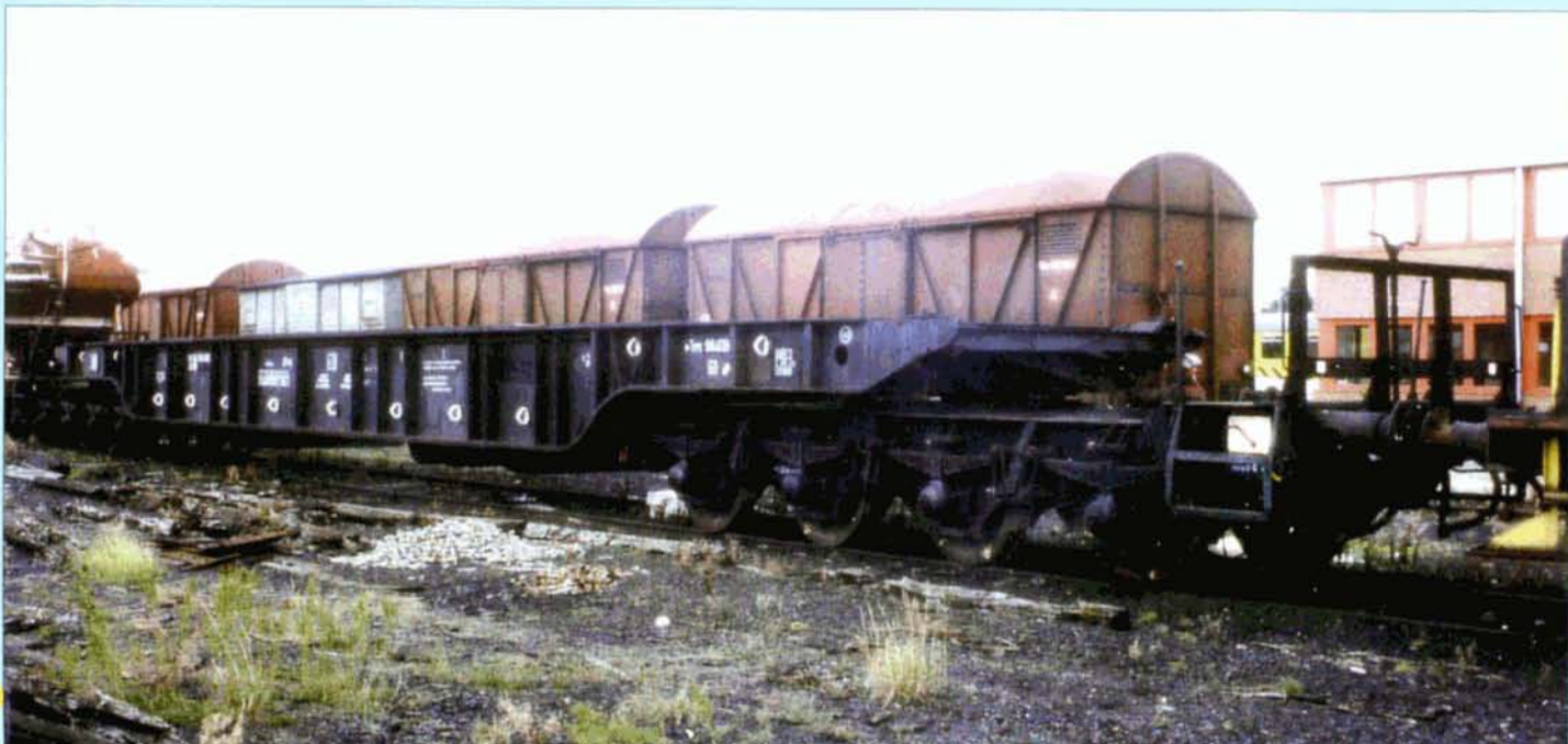
Deux photos du wagon réutilisé comme véhicule de service. Il portait alors le numéro 80 88 984 0 602-6 et servait pour l'essai sous charge des ponts roulants. Ci-dessus à Ronet au milieu des années '80. Roger CRİKELAIRE. Ci-dessous le 8 septembre 1984. Eddy VERVOORT.
