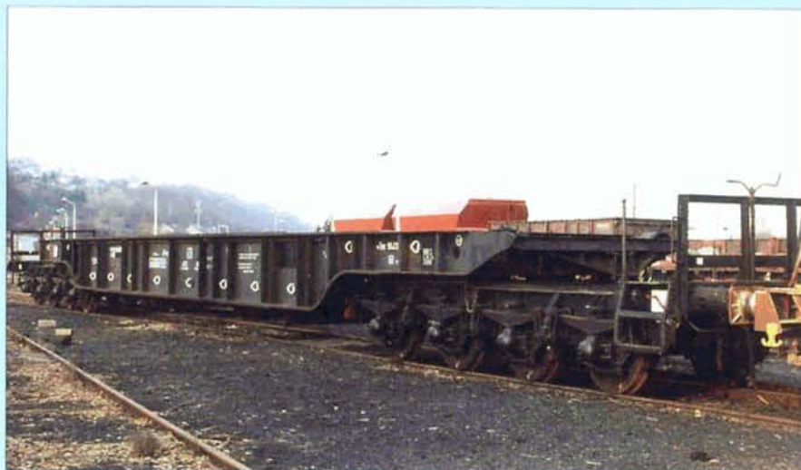
Deux photos du wagon réutilisé comme véhicule de service. Il portait alors le numéro 80 88 984 0 602-6 et servait pour l'essai sous charge des ponts roulants. Ci-dessus à Ronet au milieu des années '80. Roger CRİKELAIRE. Ci-dessous le 8 septembre 1984. Eddy VERVOORT.
