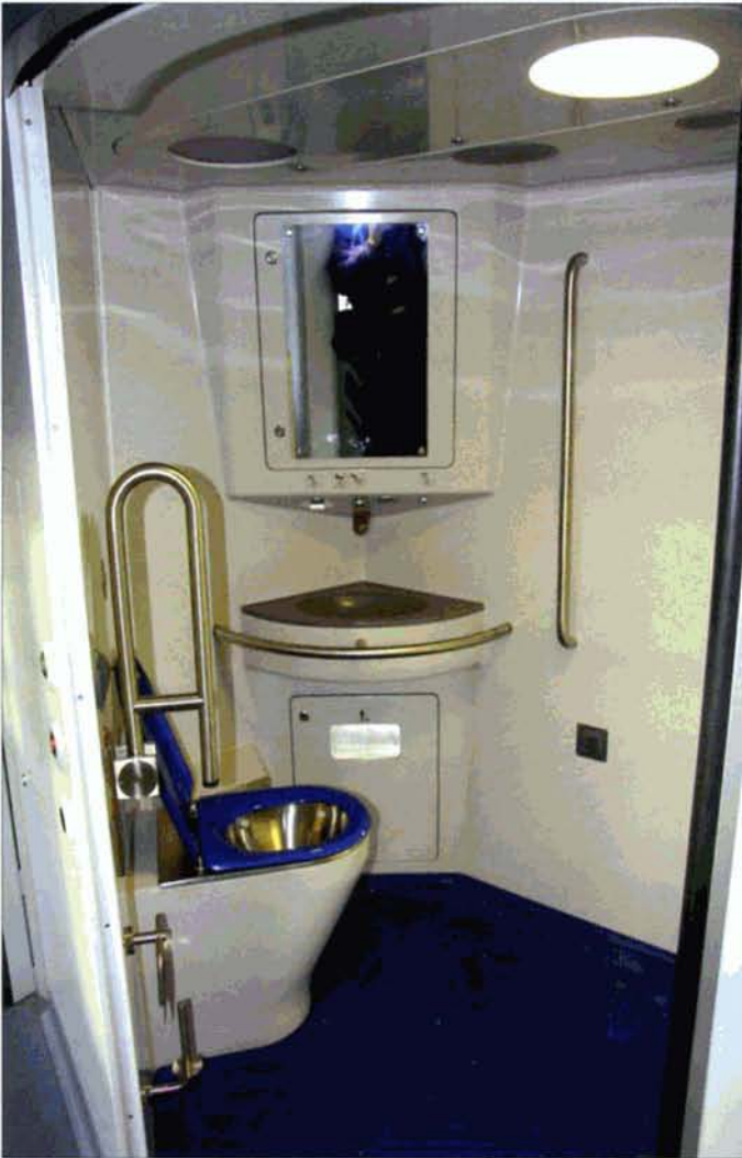
Une des nouvelles toilettes en circuit fermé. Celle-ci est spécialement aménagée pour les personnes à mobilité réduite et est adjacente au compartiment multifonctionnel.
