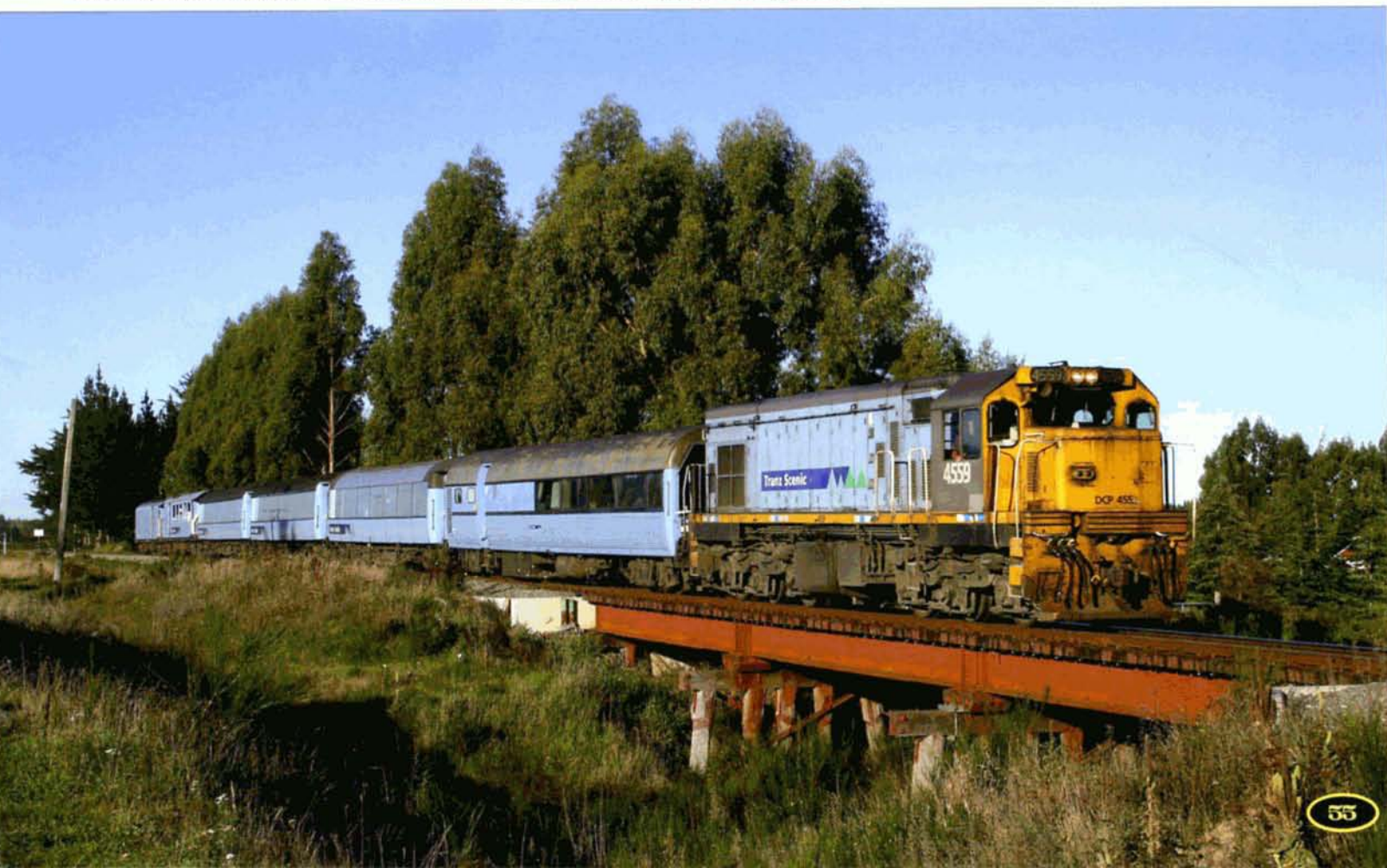
PHOTO 95-58 Il reste trois relations voyageurs longues distances, assurées par Kiwi Rail sous le label Tranz Scenic : Auckland-Wellington (Overlander), Christchurch-Picton (TranzCoastal) et Christchurch-Greymouth (TranzAlpine). Elles sont principalement destinées aux touristes. Le 29 mars 2009, la DC4559 passe à Sefton en tête du TranzCoastal Picton-Christchurch. Les DC sont des A1A A1A construites par General Motors entre 1961 et 1967. Philippe DE GIETER.
