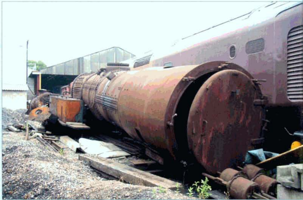
Ci-dessus, la chaudière de rechange qui équipera d'ici quelques années la 26.101. Ci-dessous, la Ty2-7173 (Wiener Lokomotief Fabriek 16626/1943) qui sera vraisemblablement revendue à un amateur. Wansford, 27 mars 2010. PFT.
