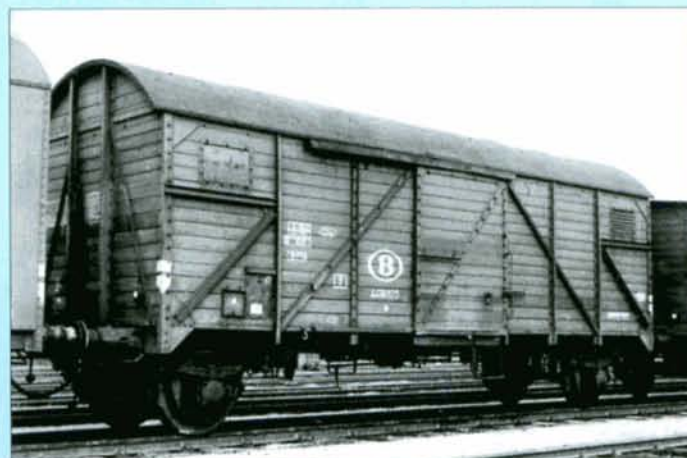
Modèle courant de wagons DR : les types "Bremen", SNCB type 2021 dont nous avons déjà traité dans le EN LIGNES 91. Il s'agit du wagon SNCB 4.416.925, ex. SNCF 9.180.498, ex. DR Pwgs-43. La SNCB racheta 33 de ces Pwgs-43 à la SNCF en 1955. Collection Charles OCSINBERG.
