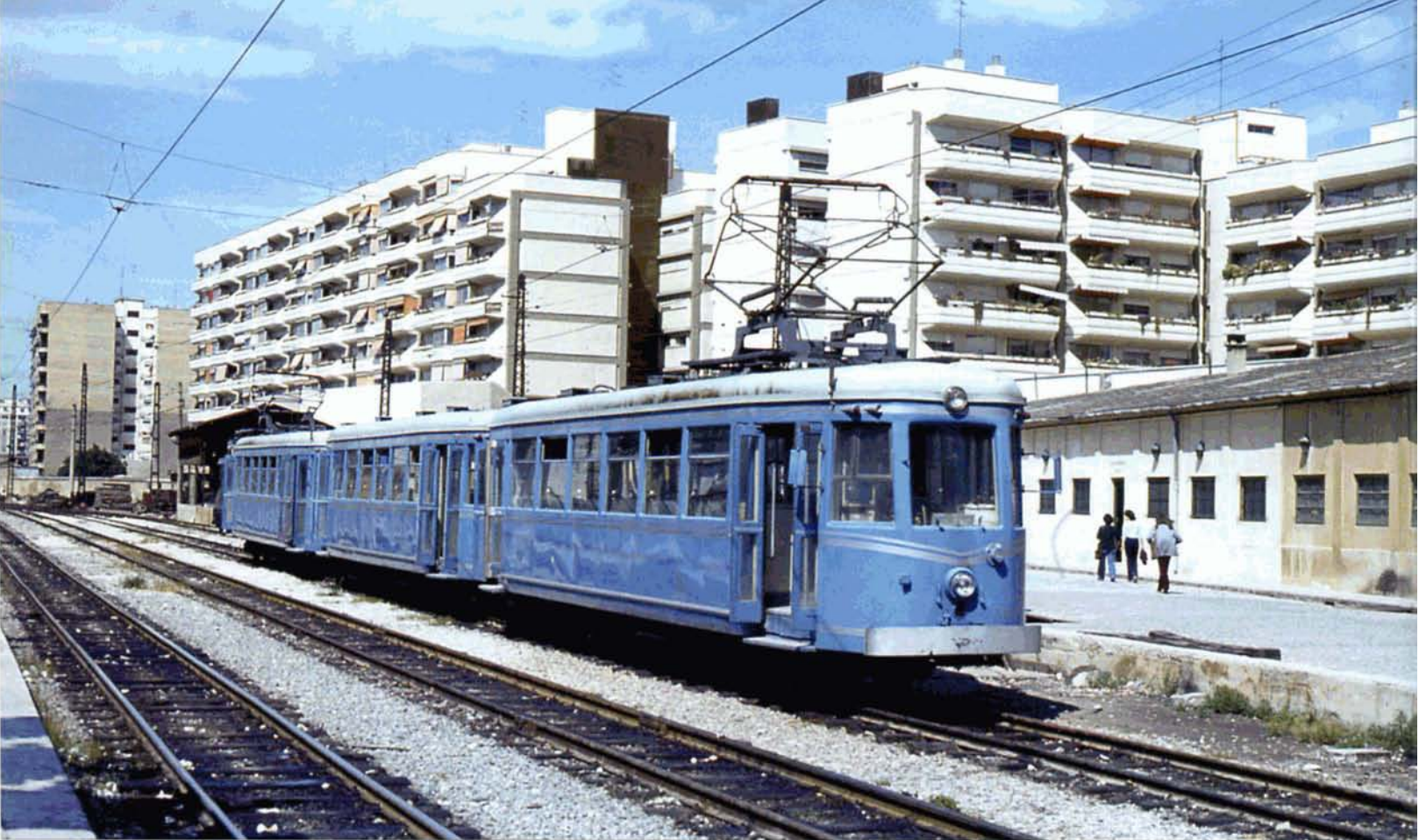
PHOTO 97-78 Le 20 mai 1980, deux motrices encadrant une remorque stationnent à la gare terminale de Puente de Madera (Pont de Fusta) à Valencia. A l'avant, la motrice 3401, qui a conservé son phare central vicinal comme toutes les motrices acquises originellement par la FEVE pour le réseau de Valencia. L'origine de cette motrice est la suivante : construite en 1930 par La Dyle et Bacalan en tant que remorque Standard n° 19.133; reconstruite en motrice Standard en 1932 et renumérotée 9991, puis en type S en janvier 1957. Elle fut acquise en 1972 par la Ferrocarriles de Via Estrache (FVE) et numérotée 3401; elle ressortit de modernisation en janvier 1986, accouplée à la remorque 6401 et la motrice 3402. Elle fut radiée avec le reste de la série le 31 janvier 1990. Pierre HERBIET.
