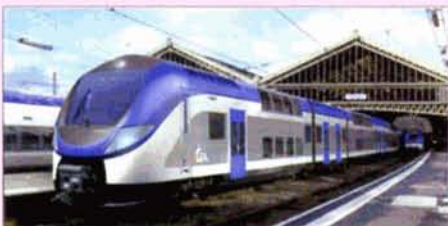
Vue d'artiste des futures rames Bombardier OMNEO Régio2N de la SNCF. On remarquera les 2e et 4e voitures très courtes, à un seul niveau, intercalées entre les voitures à deux niveaux. BOMBARDIER.
