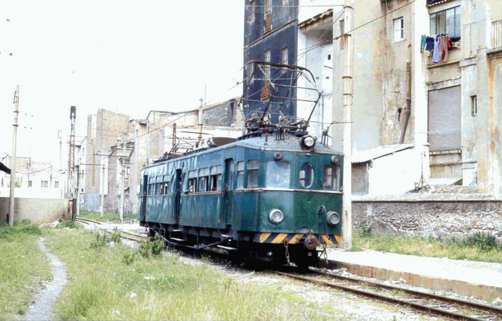
PHOTO 97-84 ↑ - PHOTO 97-85 ↓ En dehors du matériel vicinal, les FEVE possédaient une multitude d'automotrices remarquables. Sur le réseau de Valencia, des motrices datant de l'époque de l'électrification sont restées en service jusque dans les années 1980. En 1940 furent mises en service 10 motrices (n° 51 à 60) provenant de la reconstruction d'anciennes motrices datant de 1923. Construites par Construcciones Devis, elles possédaient un équipement General Electric, des bogies Brill, et 4 moteurs de traction de 50 CV. Ci-dessus, arrivée à El Grao le la motrice n° 53. Ci-dessous, une autre motrice General Electric serpente dans un faubourg assez misérable à proximité du terminus de El Grao. Photos Pierre HERBIET, 20 mai 1980.
