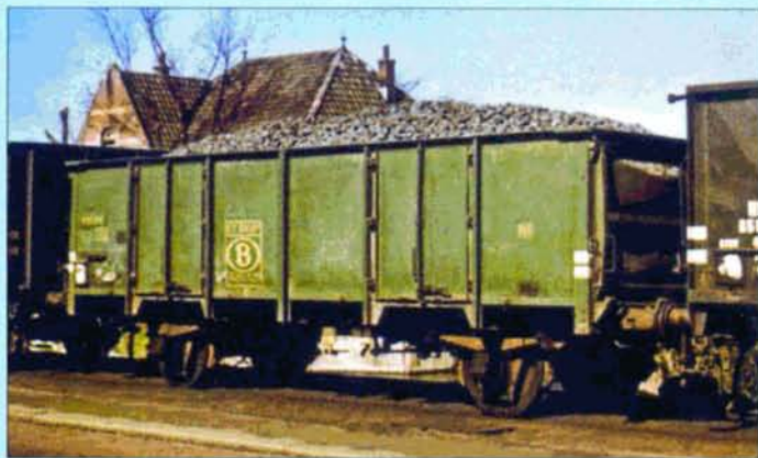
3.300 wagons tombereaux du type 1214d furent livrés par l'industrie belge à partir de 1946, numérotés 420.000 à 423.499, puis 2.265.000 à 2.268.499 en 1956. Le wagon N°420.329 est photographié à Poeldijk (NL) le 5 mai 1955. Collection Charles OCSINBERG.
