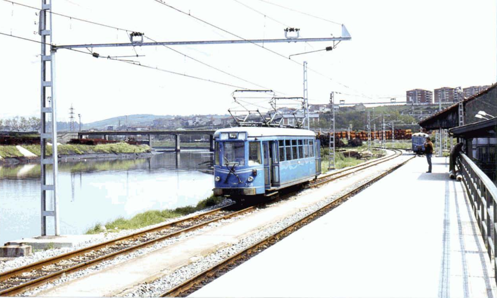
PHOTO 97-74 Après l'absorption de FC de Carreño par la FEVE, le matériel perdit sa livrée jaune vicinale pour revêtir une décoration bleue soulignée de bandes argentées. En outre, le matériel fut doté de deux feux blancs au lieu du phare central. Le 23 mai 1980, la motrice 3418 stationne au terminus d'Aviles. Il s'agit de l'ex. motrice SNCV type N 10.425 construite par l'atelier de Cureghem en juin 1950 et reconstruite en type S en 1966 pour son achat par le Ferrocarril de Carreño. Elle reçut le numéro RBfah 15 puis, après le passage à la FEVE (Norte), le numéro 3418. Au milieu des années 1980, son numéro est interverti avec la 3410, la 3418 devenant 3410" et la 3410 devenant la 3418". En mars 1986, elle ressort de modernisation, accouplée avec la remorque 6405 et la motrice 3409. Elle termina sa carrière le 31 janvier 1990. Pierre HERBIET.
