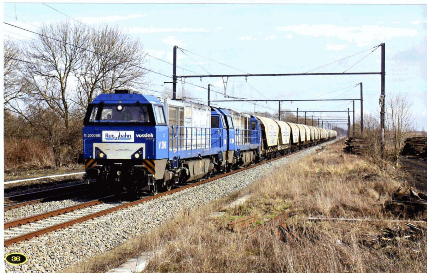
PHOTO 97-53 Le 5 mars 2010, le train de céréales 26151 à destination du port d'Antwerpen, assuré par Ruhrtalbahn/ Transport, a également été détourné par Kinkempois et la ligne 36 à la suite de la collision de Glons (voir page 13). Vu la charge élevée de la rame, deux locomotives du type G2000 - les V206 et V204 - furent nécessaires pour gravir la forte rampe de la ligne 36A Kinkempois - Voroux. Passage du train à Remicourt, entre Voroux et Waremme. Christian AUCQUIERE.
