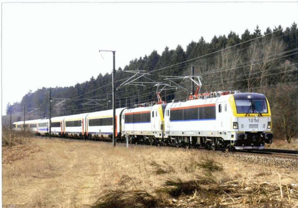
PHOTO 97-16 Du 20 au 24 mars, une nouvelle série d'essais fut réalisée entre Florenville et Bertrix, avec les 1810 et 1809 accouplées en unité multiple. La rame était composée de 6 voitures du type I10 entre lesquelles était intercalée une voiture de mesure française. A l'autre extrémité était accouplée une locomotive de la série 13 qui ramenait le train après chaque parcours. Passage du train à Saint-Médard. Wim DE RIDDER, 24 mars 2010.
