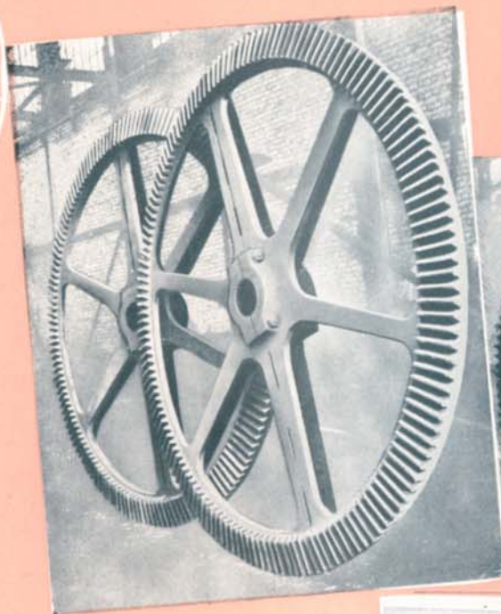
ENGRENAGES CONIQUES A DEN- TURE BRUTE. — Diamètre 2 m. 400. — En acier moulé.
