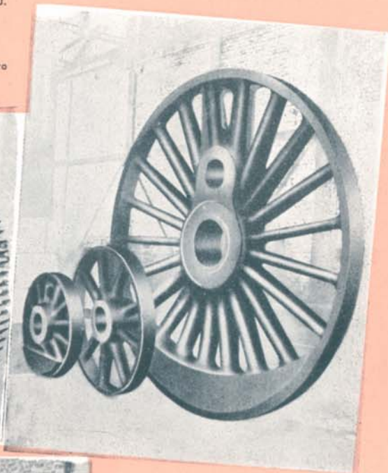
CENTRES DE ROUES DE LOCOMO- TIVES ET VOITURES en acier moulé.
