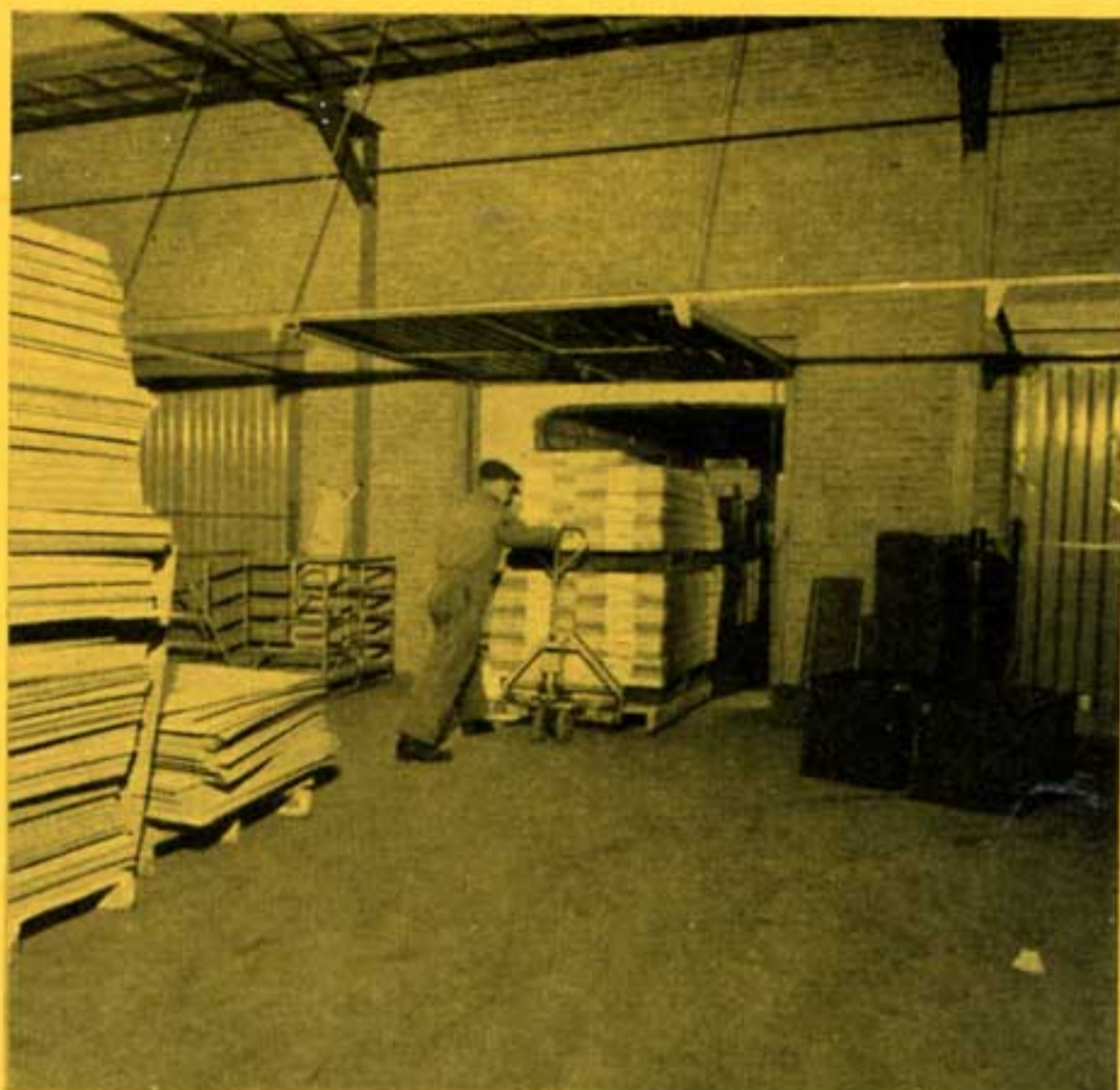
Les palettes chargées sont amenées dans le camion au moyen d'un transpalette.
