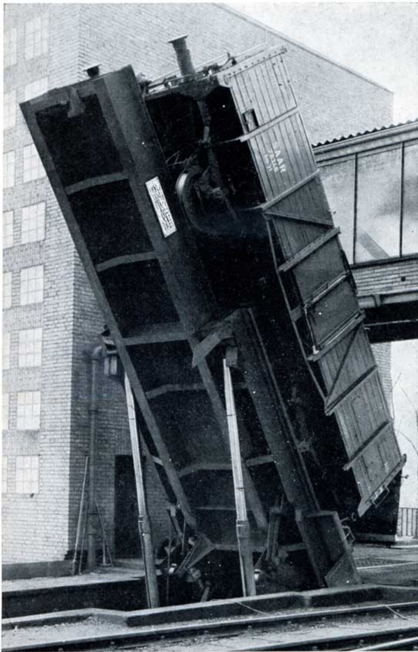
Figure 3 Culbuteur frontal unilatéral à commande électro-hydraulique.
