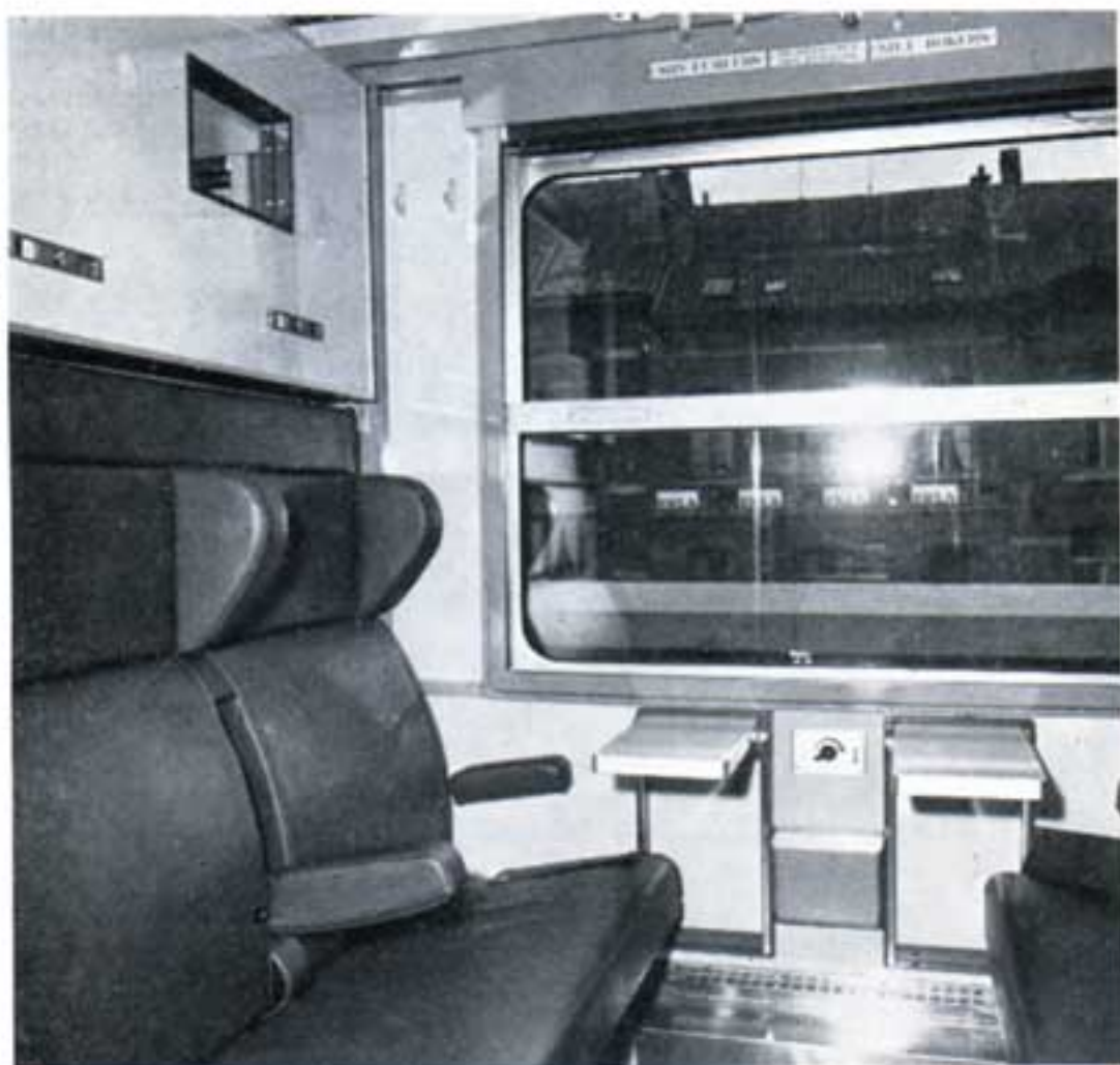
B. Intérieur d'un compartiment d'une voiture-couchettes de 2e classe (position de jour). Entre les deux tablettes escamotables se trouve la manette permettant le réglage de la température à la convenance des voyageurs.
