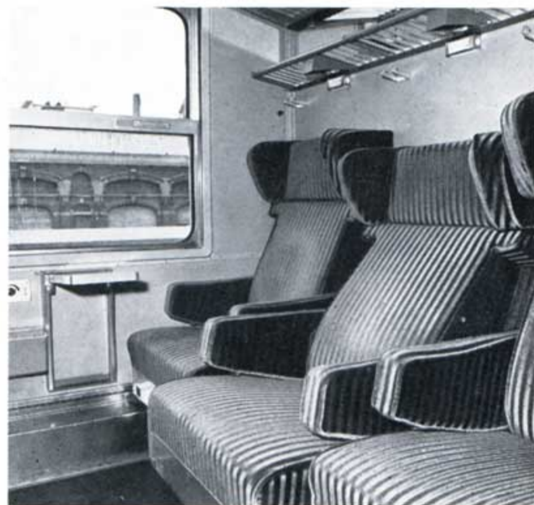
A. Compartiment d'une voiture internationale de 1ère classe. Vous remarquez un siège avancé d'environ 15 cm et le dossier ayant suivi le mouvement du siège. Cette manœuvre peut être réalisée en manœuvrant une manette encastrée, visible dans le bas de la partie frontale du siège.
