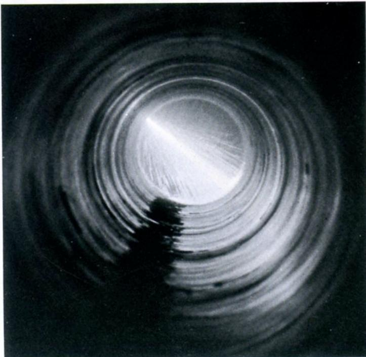
Un tube soudé en spirale passe dans la coupeuse : le rayon du chalumeau est bien visible au centre de la photo. Les Tubes de la Meuse (Tubemeuse) nous ont ouvert les portes de leurs ateliers.
