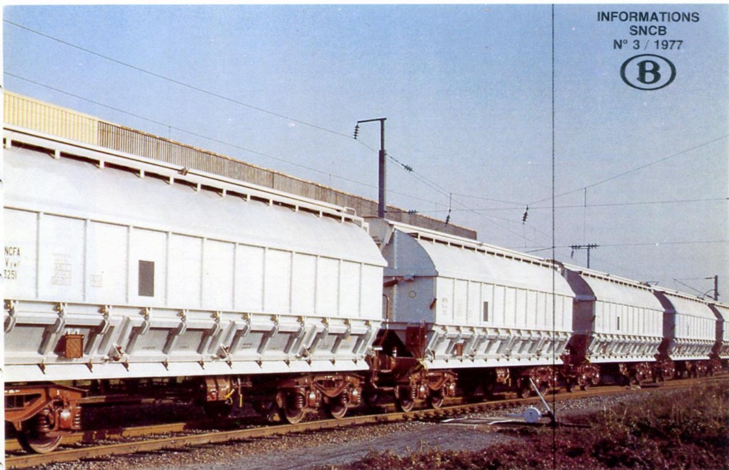
Voici un wagon spécialement conçu pour le transport de pulvérisés, granuleux et pondéreux. Construit en aluminium, il est relativement léger; totalement réalisé en acier, il aurait pesé à vide un quart de plus que son poids réel, 18,5 tonnes. On peut donc considérer que l'utilisateur, en choisissant ce wagon, gagne, à taille égale, 5 tonnes de charge utile.
