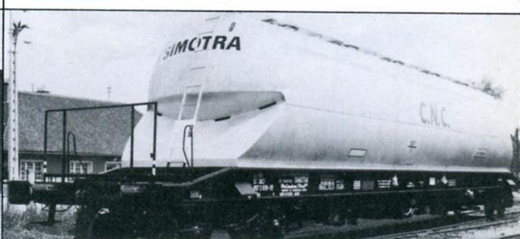
**Wagon à bogies à déchargement pneumatique pour le transport de produits pulvérulents: acide adipique, téréphtalique, craie, P.V.C., etc.**
