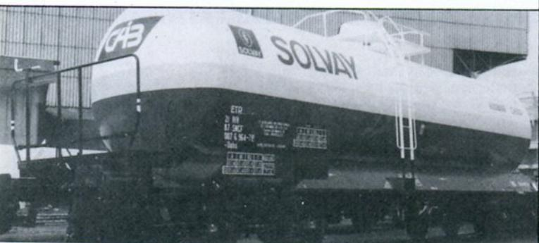
**Wagon à bogies pour le transport de gaz liquéfié sous pression: chlore.**
