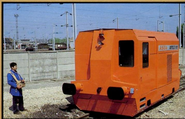
La division "Constructions Mécaniques" de Cockerill Sambre fabrique à Seraing une gamme étendue de locotracteurs à transmission hydraulique d'une puissance de 225 à 750 chevaux, à deux, trois ou quatre essieux.
