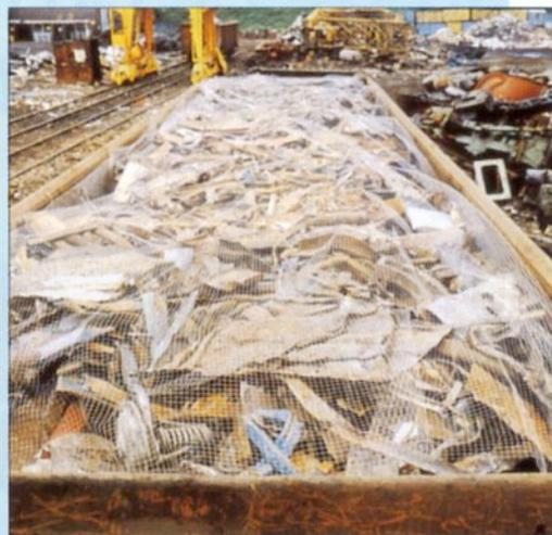
Depuis le 1er janvier 91, les chargements de ferrailles légères en vrac - par exemple de tôles d'une épaisseur allant jusque 5 mm, ou de pièces de carrosserie - doivent être couverts par un filet de protection fixé au wagon.
