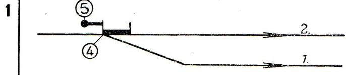
Aiguillage manœuvré par le levier 4 et muni d'un verrou (5) *normalement retiré* et pouvant verrouiller l'aiguillage dans les deux positions.
