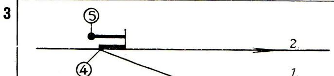
Aiguillage manœuvré par le levier 4 et muni d'un verrou (5) *normalement retiré* et pouvant verrouiller l'aiguillage en position renversée seulement.
