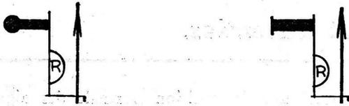
Signaux avec désengageurs pour fermeture automatique (signalisation mécanique) (1).
