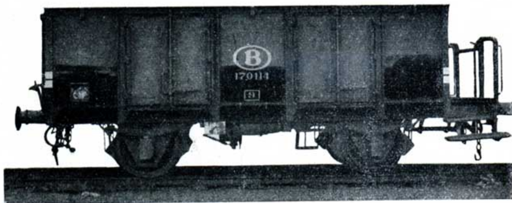
Wagon tombereau 20/25 T., à caisse en tôle E B - Flamme
