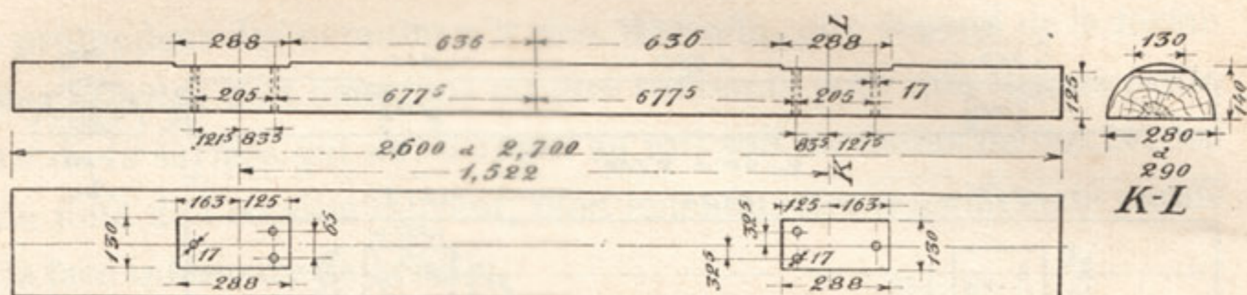
Fig. 132. — 7. Pose des rails de 50 kgr. avec plaques inclinées au 1/20^e .
