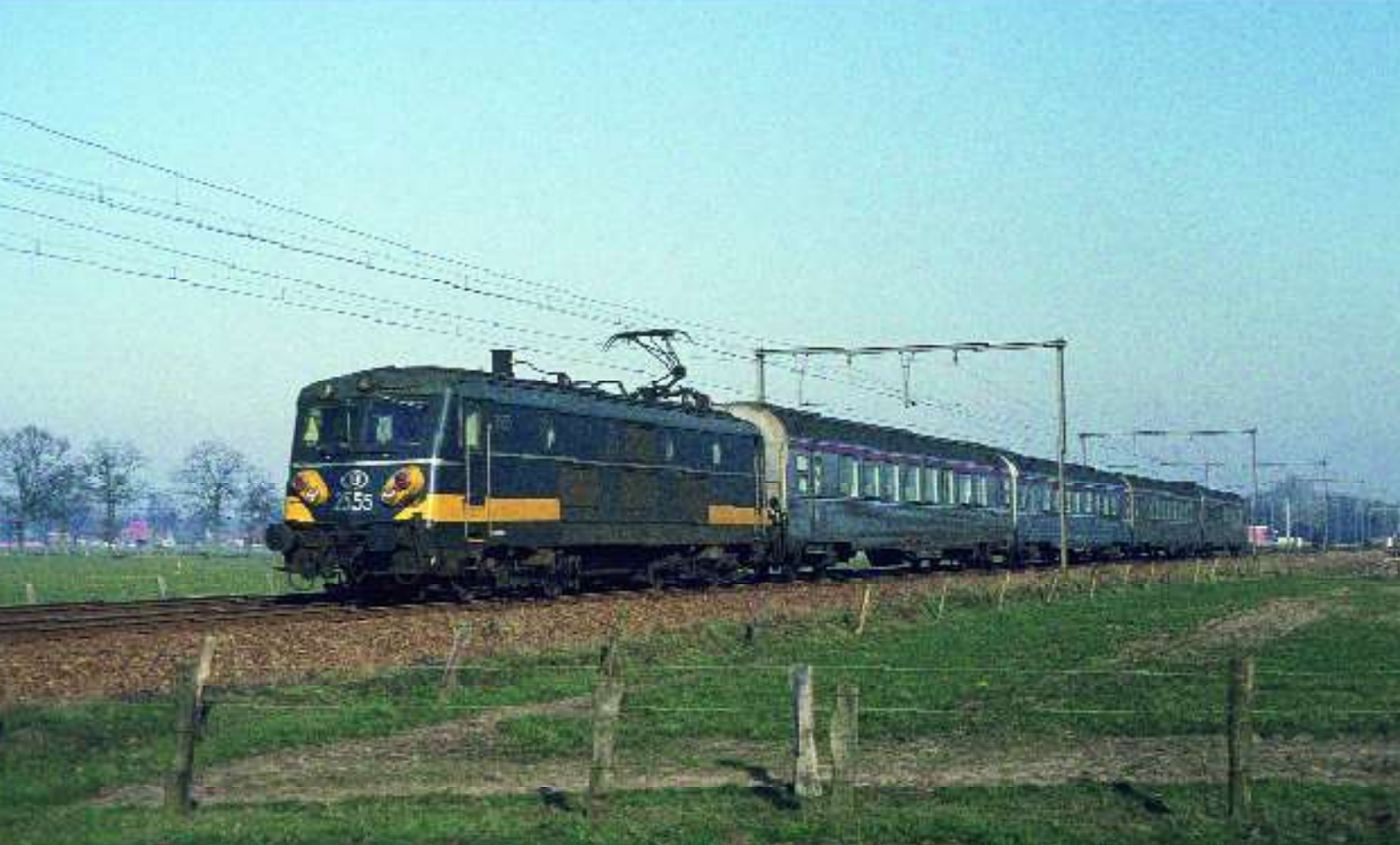
FOTOTHEMA 72 We zien hier de TEE "Etoile du Nord" op 18 februari 1982, tussen Amsterdam en Brussel-Zuid, gesleept door de 2555. Het eerste rijtuig is van het type "Mistral 69" herkenbaar aan de grotere vensters en de 10 cm hoger geplaatste rode band (vergelijk met het tweede rijtuig van het type PBA).
