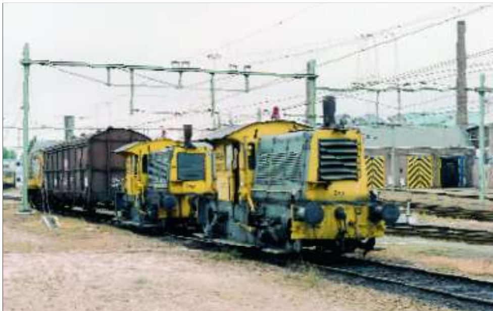
In augustus 2002 stonden de Siks 357 en 267 aan de werkplaats van Maastricht. De grote treeplank waarop de bestuurder plaats neemt om de locomotief te bedienen is zeer goed zichtbaar. Kristof AVONDS.
