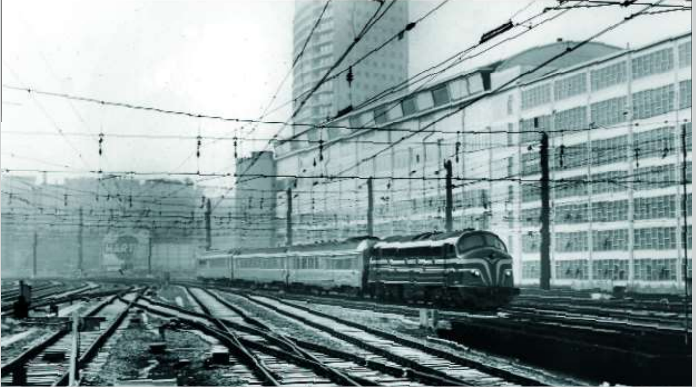
Januari 1966. De TEE 71 "Ile de France" Paris-Nord - Brussel-Zuid - Amsterdam CS, gesleept door de 204.008 van Schaarbeek, verlaat de Noord-Zuidverbinding en komt aan te Brussel-Noord. De trein bestaat slechts uit drie rijtuigen : een generatorwagen, een rijtuig met middengang en een keukenrijtuig. Daniel THIELEMANS.
