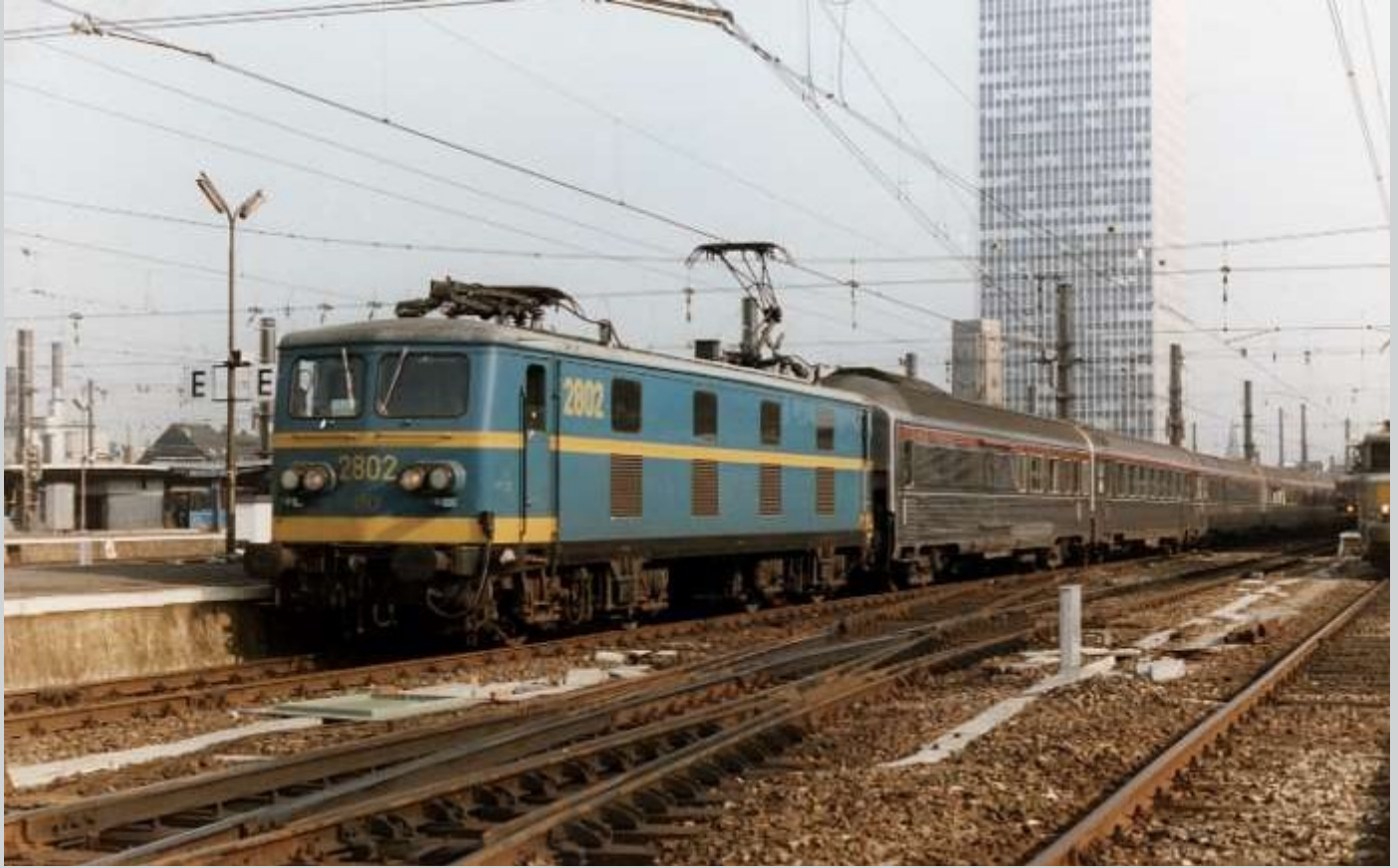
FOTOTHEMA 72 Na aankomst van TEE 81 "Etoile du Nord" Paris-Nord - Brussel-Zuid, rijdt het eerste deel van de trein verder naar Amsterdam, meestal gesleept door een locomotief van de reeks 15 of 25.5 . De rest van de trein wordt door een rangeerlocomotief naar de afstelbundel gesleept. Op 28 september 1983 gebeurde dit door de 2802. Jean-Luc VANDERHAEGEN.
