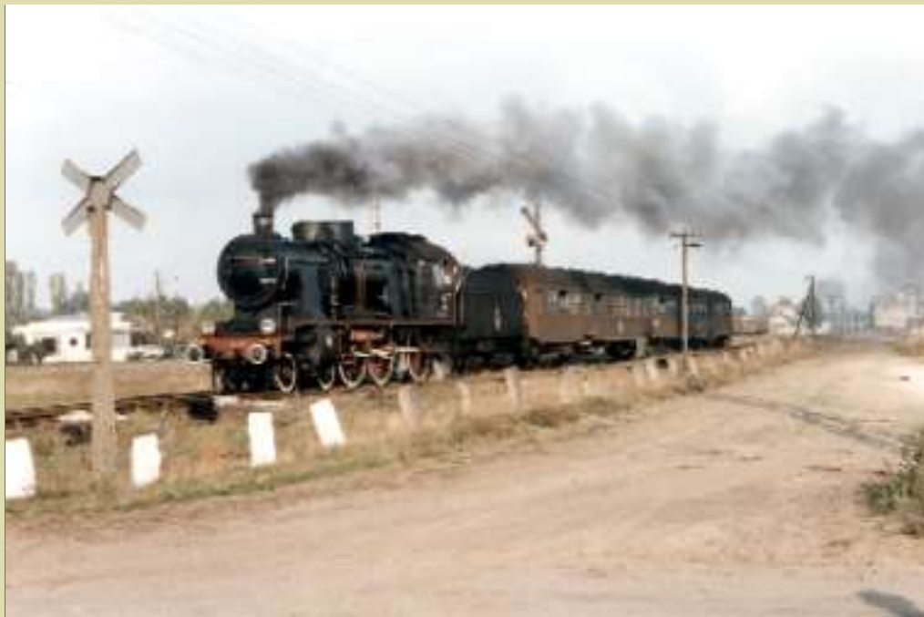
Tussen 1923 en 1935 nam de PKP een reeks van 190 nieuwe locomotieven van de reeks Ok22, afgeleid van de P8, in dienst. Hier de Ok22-31.
