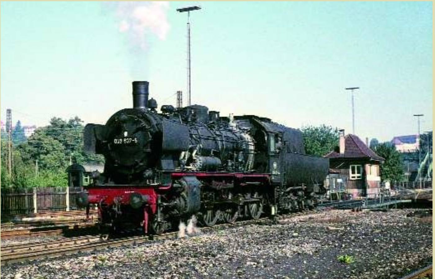
Twee P8'en van de DB werden op 18 september 1970 gefotografeerd in hun laatste depot : Bw Tübingen. De 038 057-6 is gekoppeld aan een klassieke Pruisische tender. De 038 637-5 is voorzien van een badkuiptender, afkomstig van een Kriegslok BR 52. Foto's : Jef Van OLMEN
