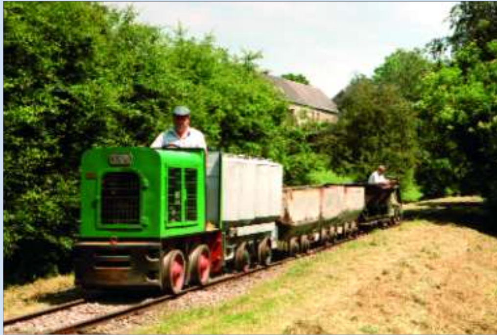
CFS bezit een uitgebreide collectie spoorwegmateriaal voor 60cm-spoor. Hier een Schöma met mijnwagens op de ex-NMVB-lijn Trooz - Sprimont - Poulseur. Christian Dosogne.
