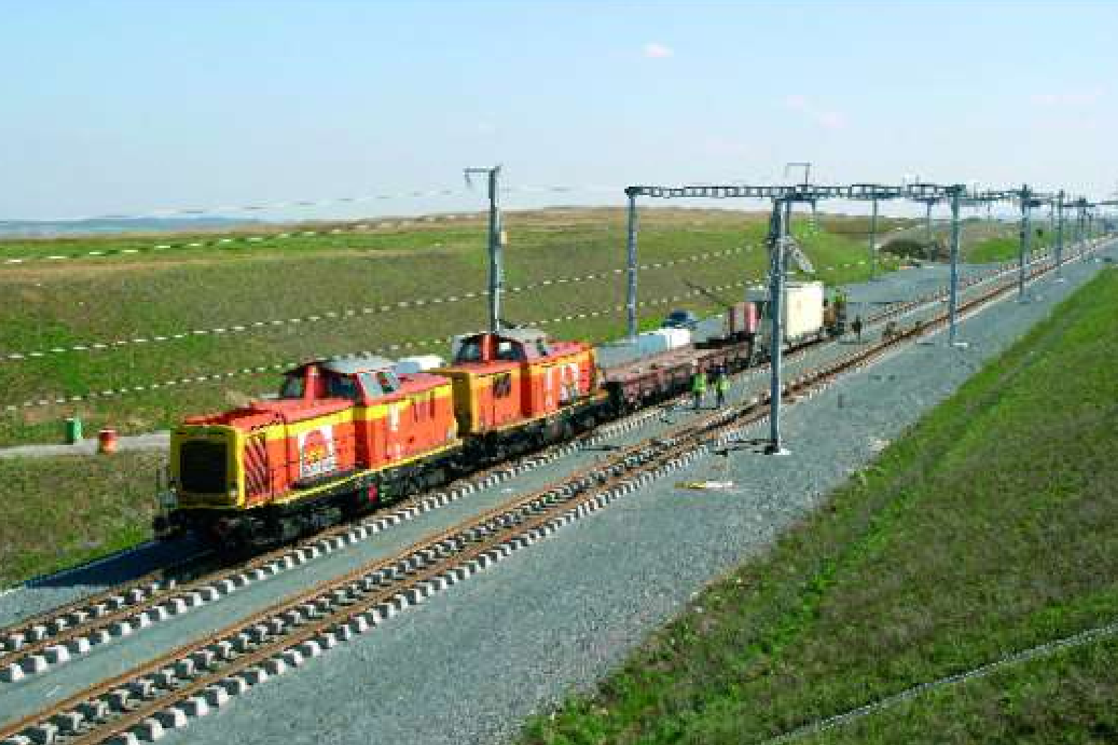
FOTO 74-21 Een trein van SECO-Rail gesleept door twee locs, ex-211 van de DB.
