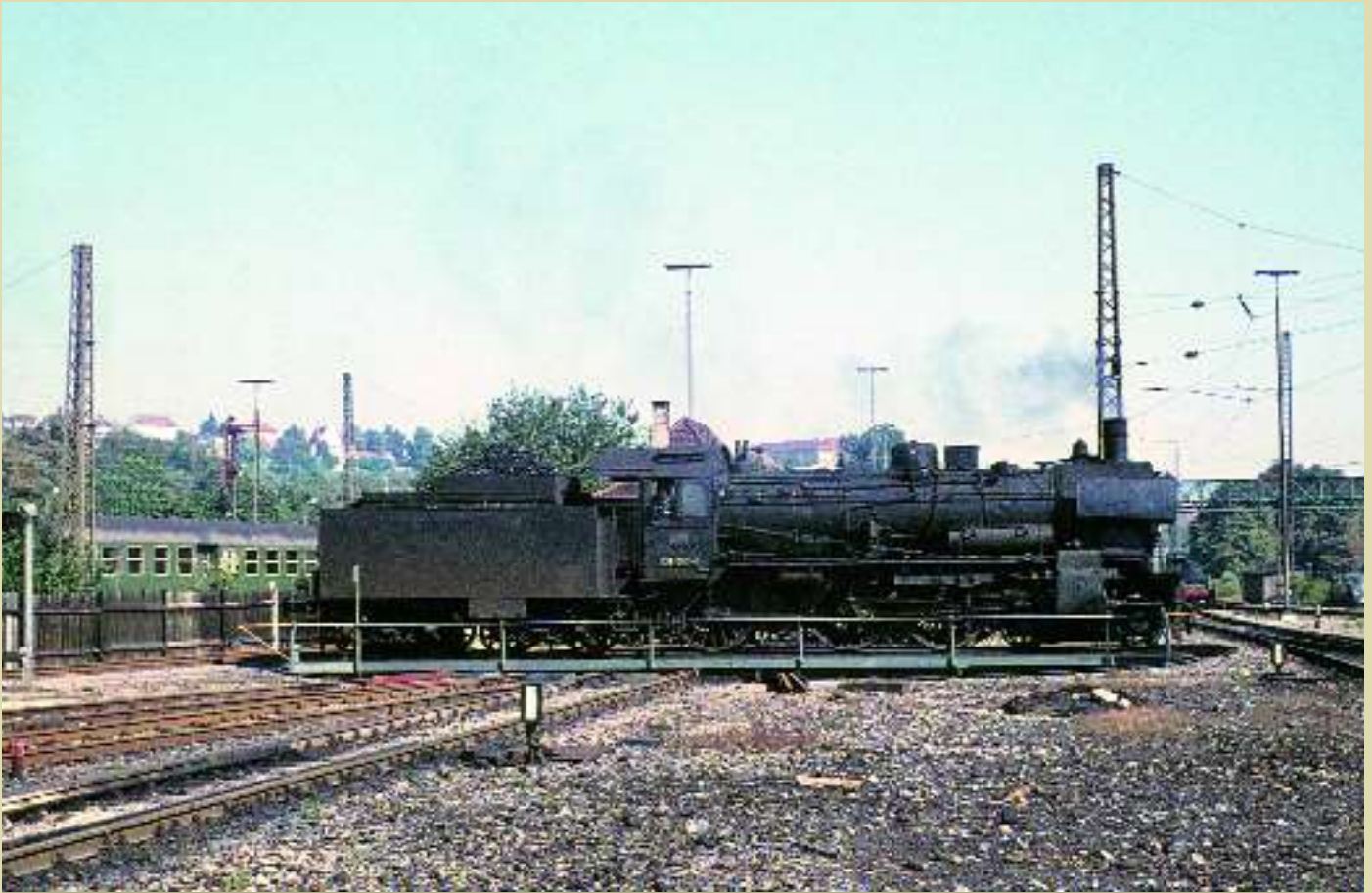
Twee P8'en van de DB werden op 18 september 1970 gefotografeerd in hun laatste depot : Bw Tübingen. De 038 057-6 is gekoppeld aan een klassieke Pruisische tender. De 038 637-5 is voorzien van een badkuiptender, afkomstig van een Kriegslok BR 52. Foto's : Jef Van OLMEN
