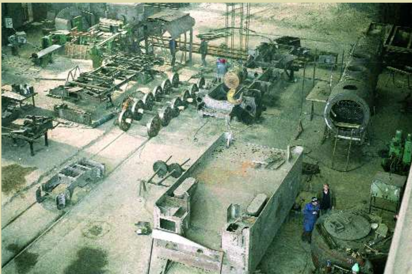
Deze foto, eveneens uit november 2002, geeft ons een zicht van de volledige werf. Van rechts naar links ziet men de stoomketel, het chassis van de locomotief, het wielstel en het onderstel van de tender met daarachter het machinistenhuis. Op de voorgrond bevindt zich de tenderkast, de zuigers en het chassis van het draaistel.
