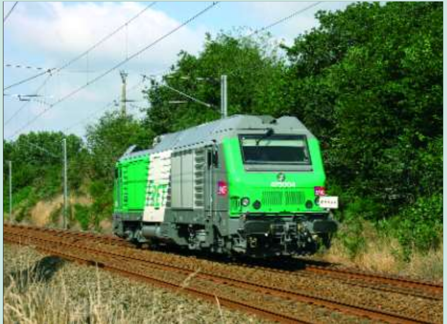
De 475004 gefotografeerd op 8 augustus 2006 tijdens proefritten op spoor 2 tussen de stations van Plouaret le Tregor en Plounérin in Bretagne op de lijn Paris - Brest. De testen moesten de invloed op de spoorstroomkringen en de elektromagnetische stromen nagaan.
