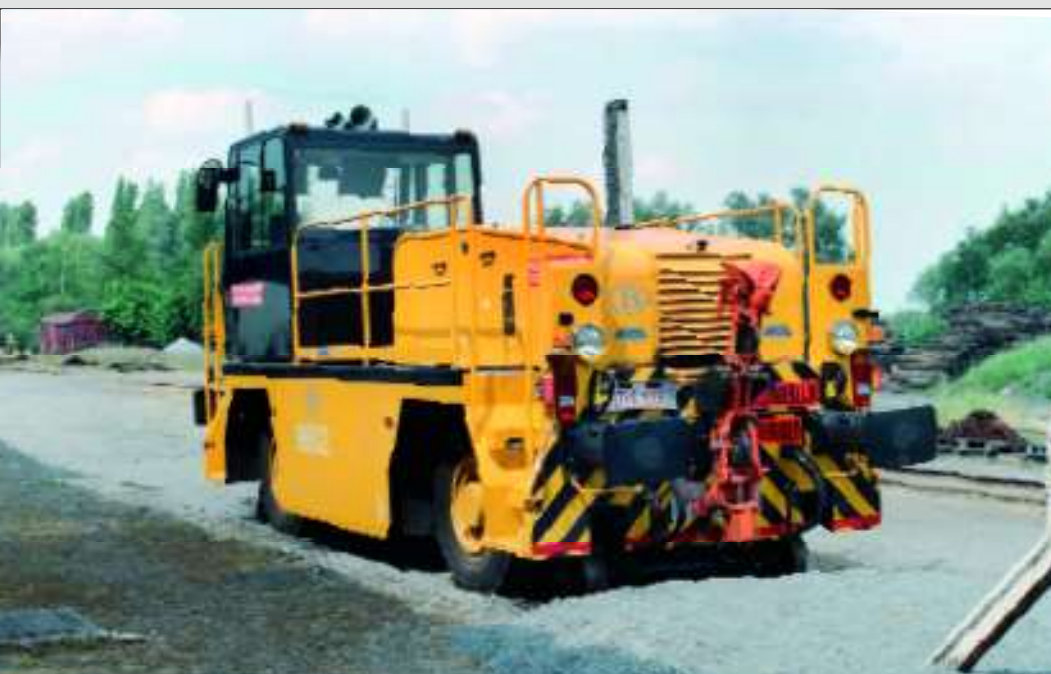
De 9119 van Hasselt, die gebruikt wordt voor rangeringen in de werkplaats, heeft een nieuwe uitlaat gekregen die ervoor moet zorgen dat de rookontwikkeling afneemt. Dit vreemd uitzijnde onderdeel werd op het dak van de cabine geïnstalleerd. Hasselt, 12-07-06.
