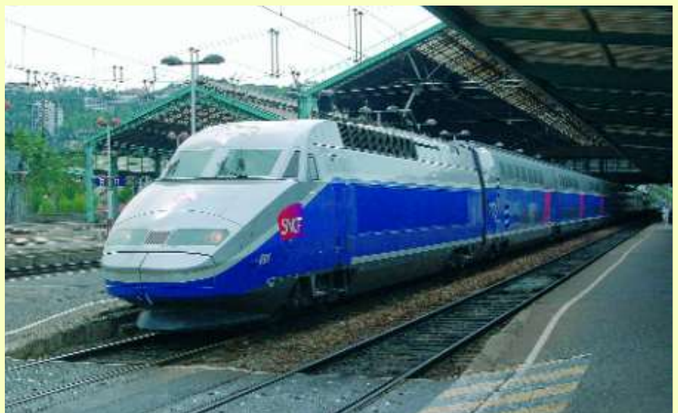
FOTO 75-26 Op 28 juni 2006 wacht de TGV 6668 Lyon-Perrache - Paris-Lyon op het vertrek. De trein wordt verzekerd door het eerste hybride-duplexstel, de 601. Opvallend is de stroomlijn van de neus en de voorruit in twee delen van de motorrijtuigen. Christian. VANHECK.
