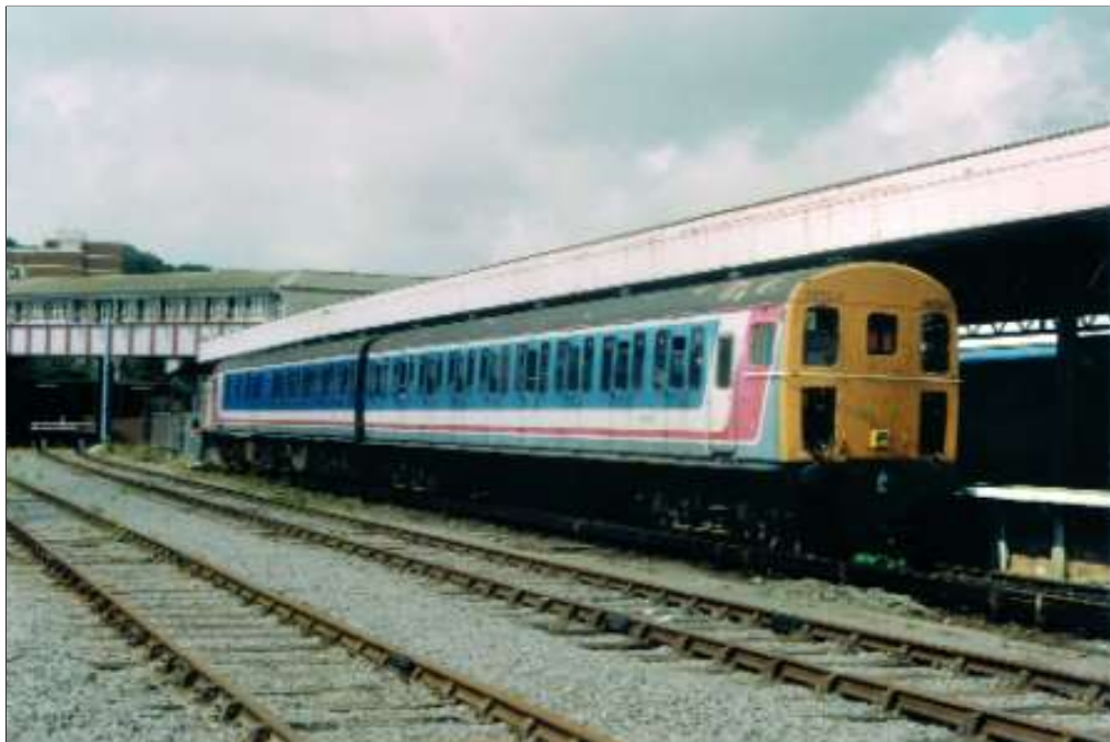
FOTO 75-15 Op 21 juli 1998 wacht het tweeledig dieselstel 207 017 op het volgende vertrek te Hastings. Deze stellen werden in 1962 gebouwd door de werkplaats van British Rail te Eastleigh. Oorspronkelijk bestonden ze uit een motorrijtuig (English Electric-dieselmotor van 450 kW), een stuursstandrijtuig en een tussenrijtuig. Philippe DE GIETER.
