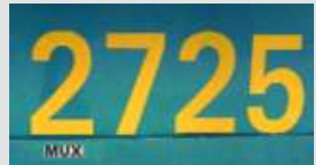
De 27'ers MUX verloren hun TS-kabels (links) en de contactdozen (rechts) nodig voor rijden in treinschakeling. Een extra vermelding MUX werd aangebracht op de zijwand onder het nummer (foto onder).
