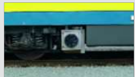
Alle elektrische locomotieven, met uitzondering van de reeksen 22, 23 en 25, worden uitgerust met een airco voor de stuurposten. Een gedeelte van deze installatie werd aangebracht onder het chassis bij de reeksen 21/27.
