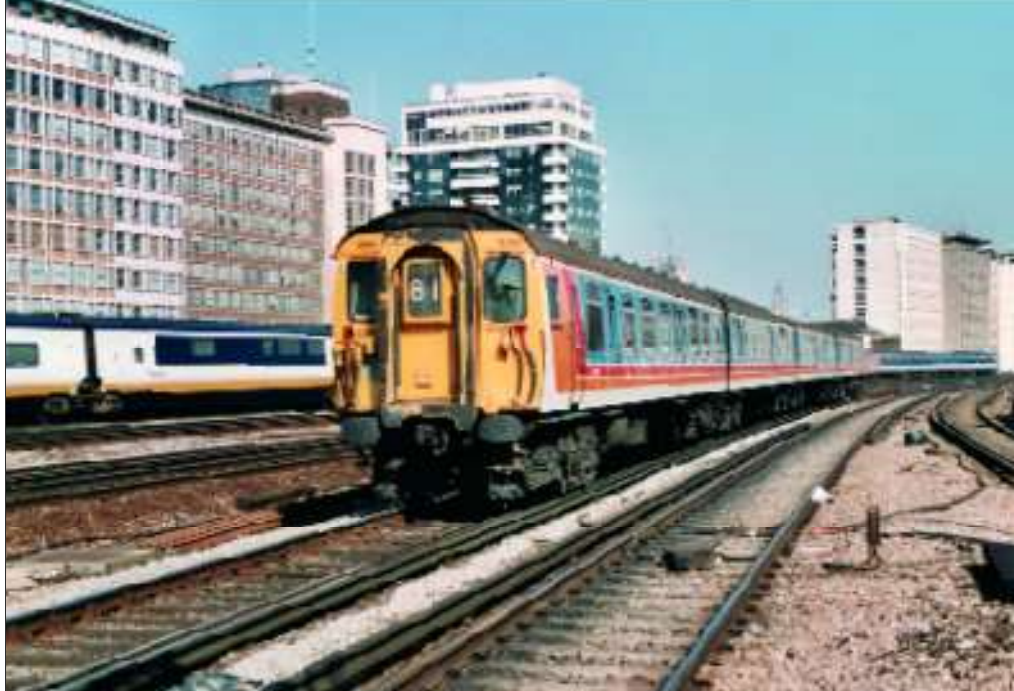
Op 28 september 1994 komt motorstel 1962 (Class 411/5) aan te London Vauxhall. Dit materieeltype kwam vanaf 1956 in dienst en bezat vier kasten : twee motorrijtuigen (370 kW elk) die twee tussenrijtuigen omkaderden. Kristof AVONDS.
