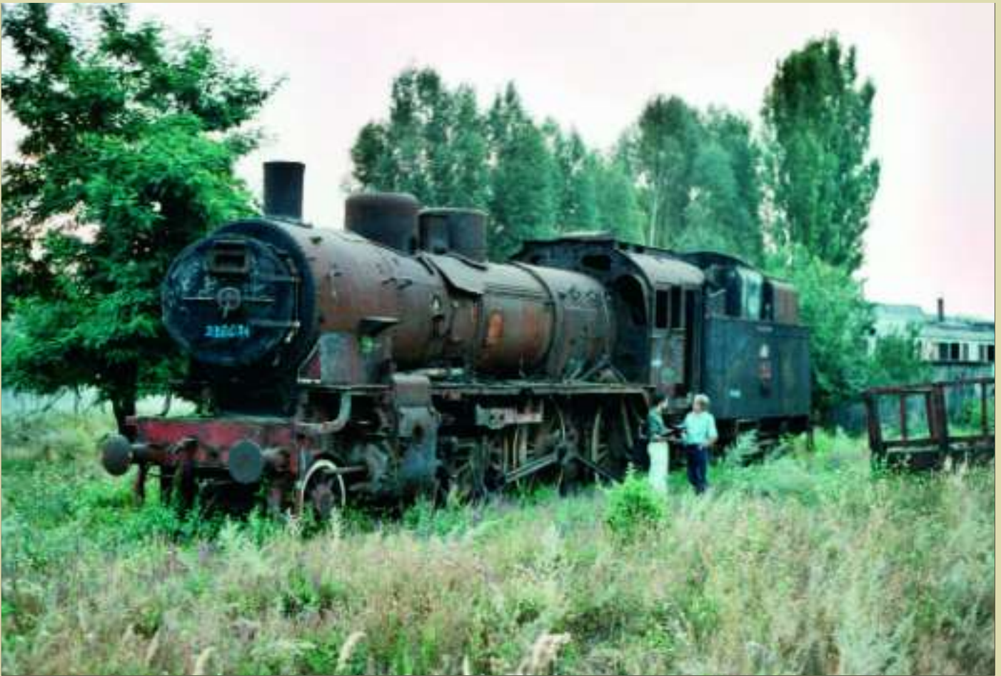
FOTO 75-14 Dit was de toestand van de 230.084 voor haar aankoop door het TSP. Ze stond afgesteld in de remise van Bucuresti. Op het eerste zicht was haar toestand niet schitterend. Talrijke belangrijke onderdelen zijn verdwenen. TSP.
