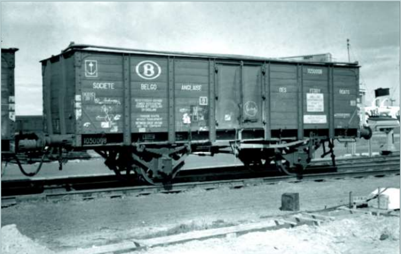
FOTO BD-239 Wagen Ff 1.05.008 in Zeebrugge op 6 april 1957. Deze wagen kon met een dekzeil uitgerust worden en heeft nog zijn oude glijlagers. Bruno DEDONCKER, verzameling TSP.
