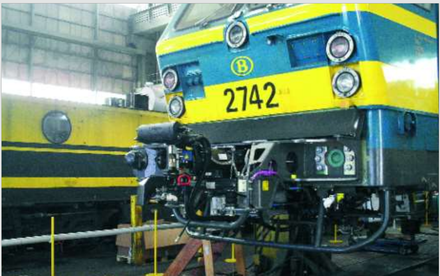
Alle elektrische locomotieven, met uitzondering van de reeksen 22, 23 en 25, worden uitgerust met een airco voor de stuurposten. Een gedeelte van deze installatie werd aangebracht onder het chassis bij de reeksen 21/27.
