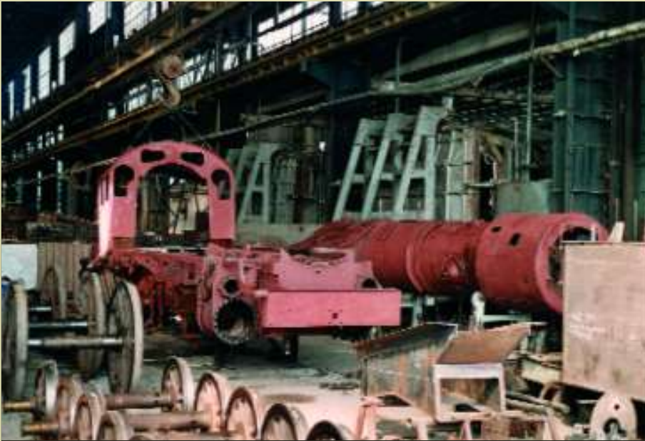
April 2003 : het machinistenhuis wordt terug op het chassis geplaatst.
