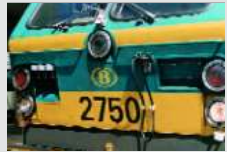
De 27'ers MUX verloren hun TS-kabels (links) en de contactdozen (rechts) nodig voor rijden in treinschakeling. Een extra vermelding MUX werd aangebracht op de zijwand onder het nummer (foto onder).
