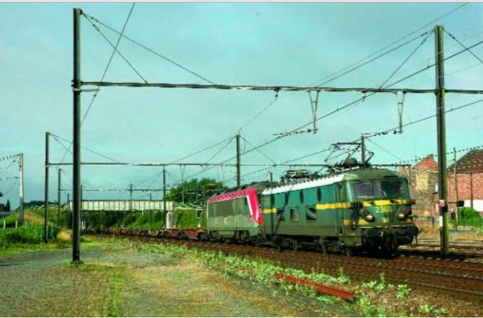
FOTO 75-50 Op 10 juli 2006 waren de witte frontlichten van de 36005 SNCF defect bij de aankomst in België. Omdat witte frontlichten verplicht zijn, moest de 2368 de trein slepen tussen Mons en Antwerpen-Noord. Doortocht te Jurbise van de 47805 Aulnoye (08.00) - Antwerpen-Noord (11.45). Pierre HERBIET.
