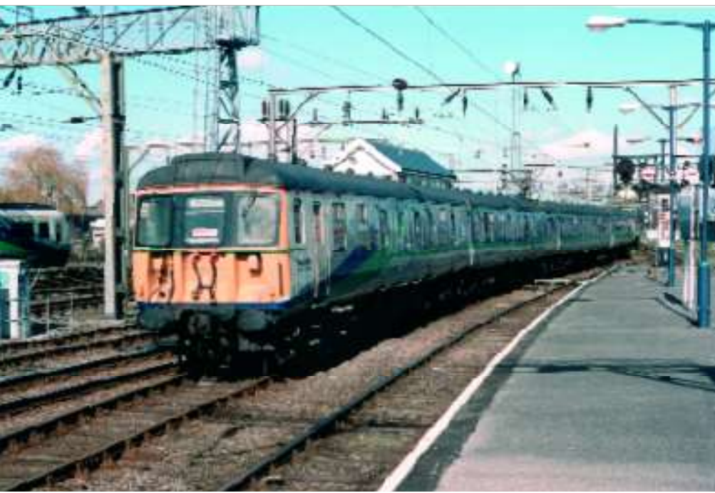
FOTO 75-16 Vertrek van het motorstel 312 721 (25 kV) te Clapton op 13 maart 2004. De motorstellen Class 312, vanaf 1975 ingezet op het Britse net, bestonden uit 4 rijtuigen. Het enige motorrijtuig (806 kW) is waarneembaar in tweede positie. Philippe DE GIETER.
