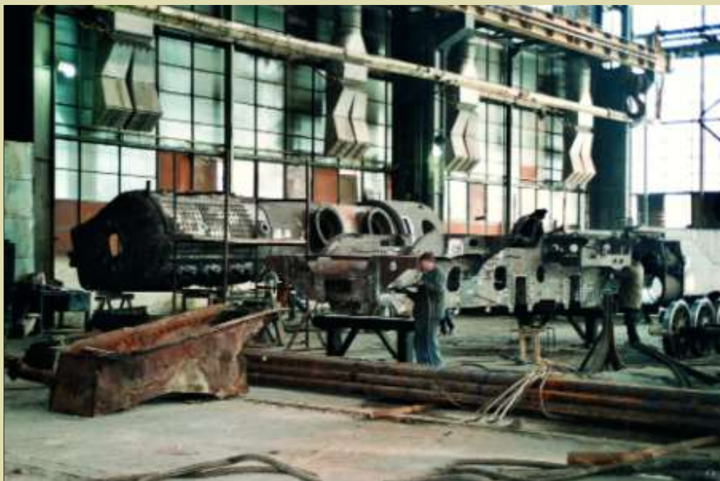
November 2002 : na het zandstralen van het chassis, kon men beginnen met de montage. Links ligt de asbak van de vuurhaard en op de achtergrond de stoomketel.
