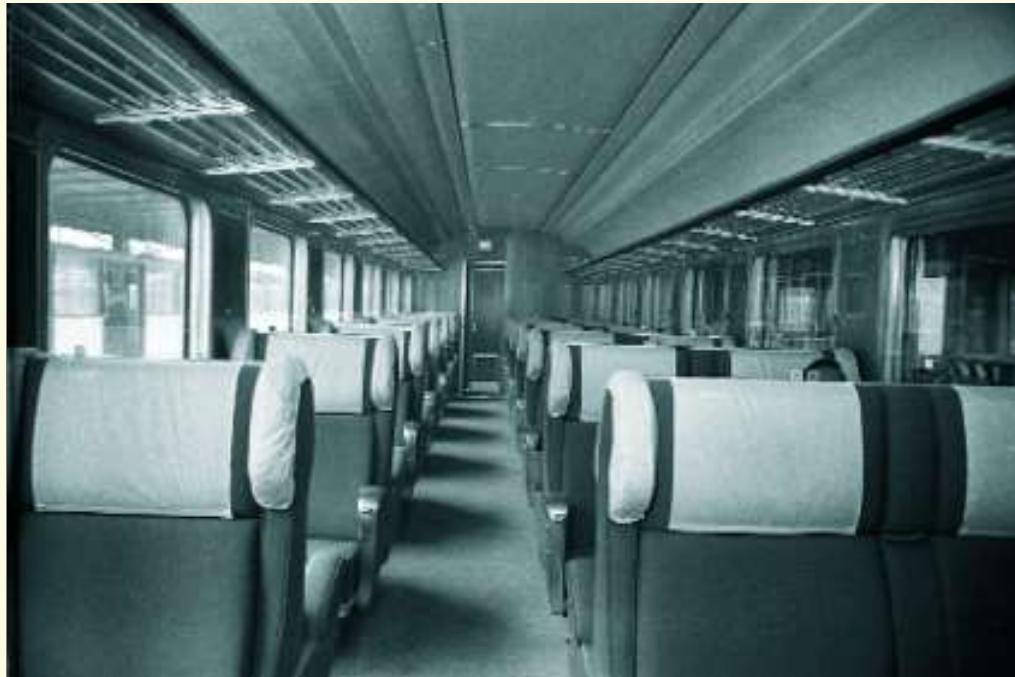
FOTO BD-247 Zicht op de binneninrichting van een coachrijtuig met centrale gang van een Nederlands-Zwitsers TEE-stel, met een capaciteit van 42 plaatsen. Het gaat hier om het stuurstandrijtuig. Bruno DEDONCKER, verzameling TSP ©.
