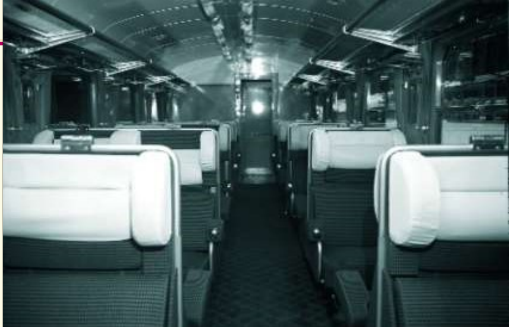
FOTO BD-250 Zicht op de binneninrichting van de RGP/TEE-stellen van de SNCF. Elk rijtuig van het type coach bevatte slechts één grote afdeling met centrale gang en 39 plaatsen (motorwagen) of 42 plaatsen (bijwagen met stuurpost). Bruno DEDONCKER, verzameling TSP ©.
