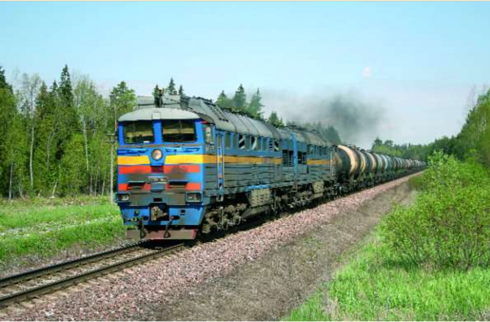
FOTO 81-20 Spacecom is eveneens een Russische maatschappij. Zij waarborgt het merendeel van het petroleumvervoer tussen het grensstation van Petseri (lijn naar Moskou) en Tallinn. Het tractiepark omvat 10 locomotieven van het type 2TE116, deze zijn allemaal in het blauw met gele streep geschilderd. Op 20 mei 2007, passeert de 2TE116-1697 te Raake met een lege petroleumtrein op weg naar Rusland. Jean-Luc VDH.
