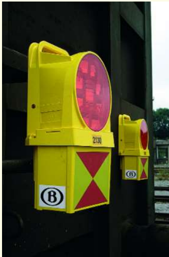
Links : close-up van de nieuwe Magelan-eindseinlantaarns van de NMBS. Hierboven zien we het pictogram, aangebracht op de locomotieven die met dit type lantaarns zijn uitgerust; in dit geval de 7731. Laurent JOSEPH.
