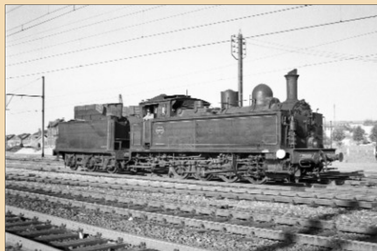
FOTO BD-266 Drie types 53 van Jemelle, gekoppeld aan een tender om te kunnen rangeren te Marloie, er kon daar immers geen water genomen worden. Hier de 53.010 te Marloie op 14 juni 1957.
