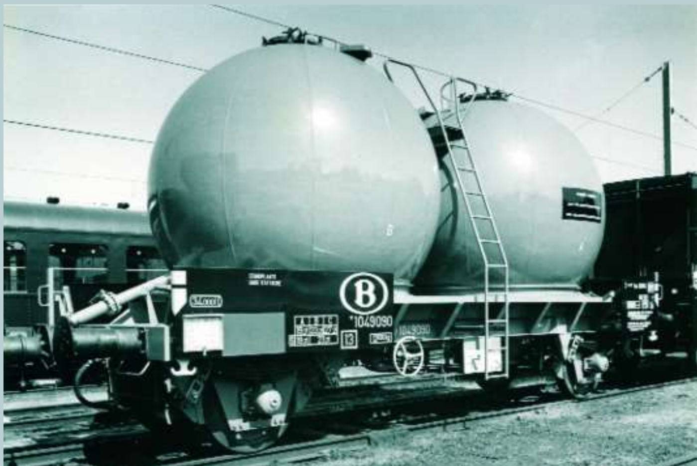
De Ucs-wagon type 2000G 1.049.090, gefotografeerd bij het verlaten van de fabriek. Vooraan, tussen de buffers, zijn de drukluchtleidingen zichtbaar die dienen voor het legen van de reservoirs. Verzameling TSP.
