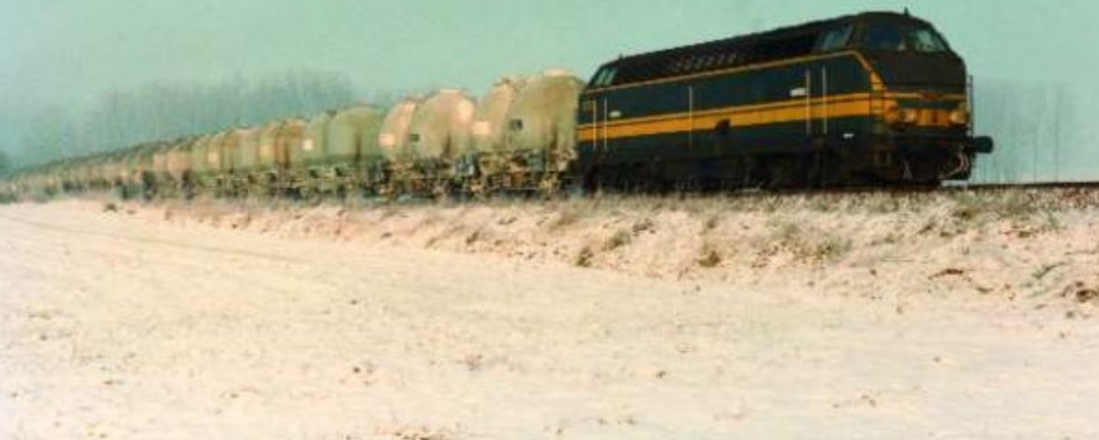
FOTO 81-56 Net voor het station van Viane-Moerbeek passeert op 5 januari 1985 een lege cementtrein 39890 St-Niklaas - Obourg, gesleept door de 6254 van Ath. De eerste twee wagens zijn van het type Ucs 2000G2. De andere, modernere wagens, behoren tot de types 2000G3 t/m 6.
