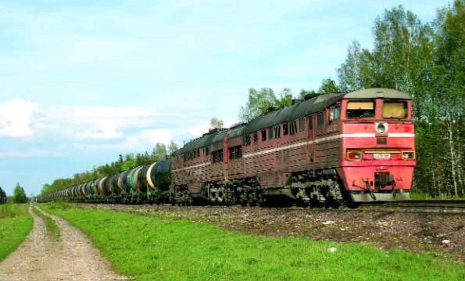
FOTO 81-19 De Russische maatschappij Transoil verzorgt hoofdzakelijk het petroleumvervoer tussen het grensstation van Narva (lijn naar Sint-Petersburg) en Tallinn. Transoil bezit 37 locomotieven van het type 2TE116, (CoCo+CoCo) met een vermogen van 4500 kW, die door Lugansk werden gebouwd in 1625 eenheden vanaf 1972. Hier de doortocht te Oru van een petroleumtrein die naar Tallinn gesleept wordt door de 2TE116-586. Buiten het gemeenschappelijke gedeelte tussen Tallinn en Tapa, is de lijn enkelsporig, ondanks de intensiteit van het verkeer. De talrijke kruisingsstations laten een goede doorstroming van het verkeer toe. Yves STEENEBRUGGEN.
