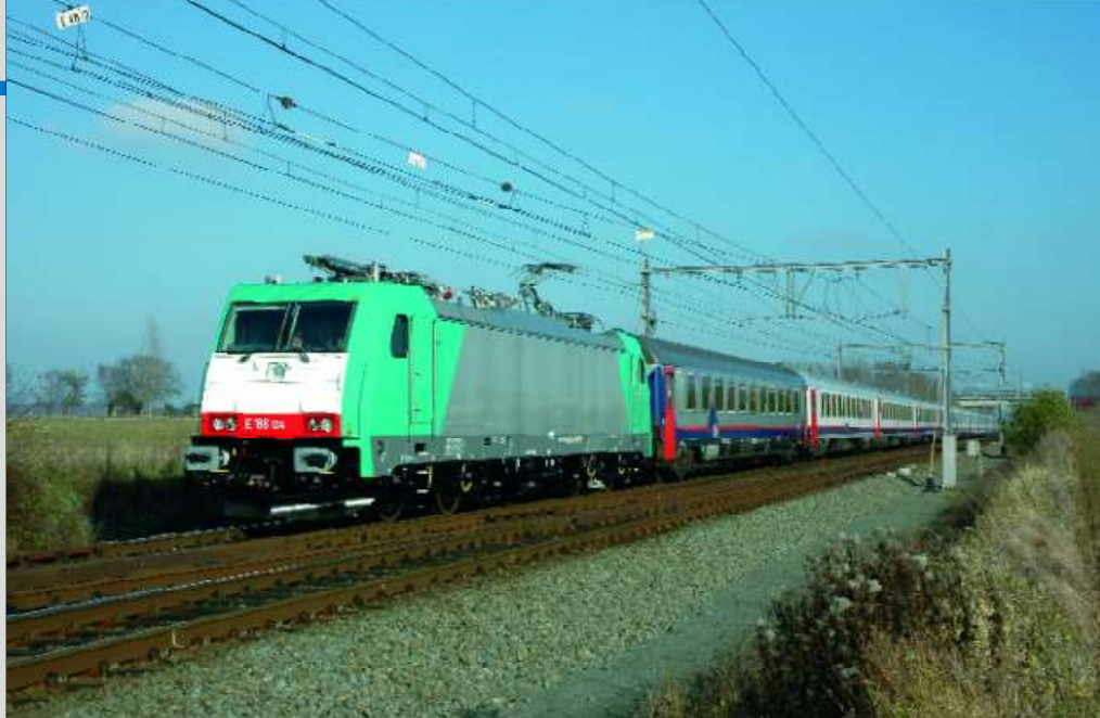
FOTO 83-33 TRAXX E186 124 tijdens de nieuwe elektromagnetische compatibiliteitstesten tussen Silly en Ath op 18 november 2007. Philippe GOUSSET.
