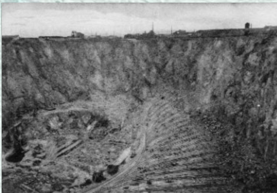
Deze twee foto's tonen het diepste punt van de groeven Tacquenier en Cosyns met de talrijke verplaatsbare, in waaivorm aangelegde sporen, tot tegen de ontginningsplaats voor de afvoer van de stenen naar de verwerkinginstallatie. De onderste foto dateert van 1920.
