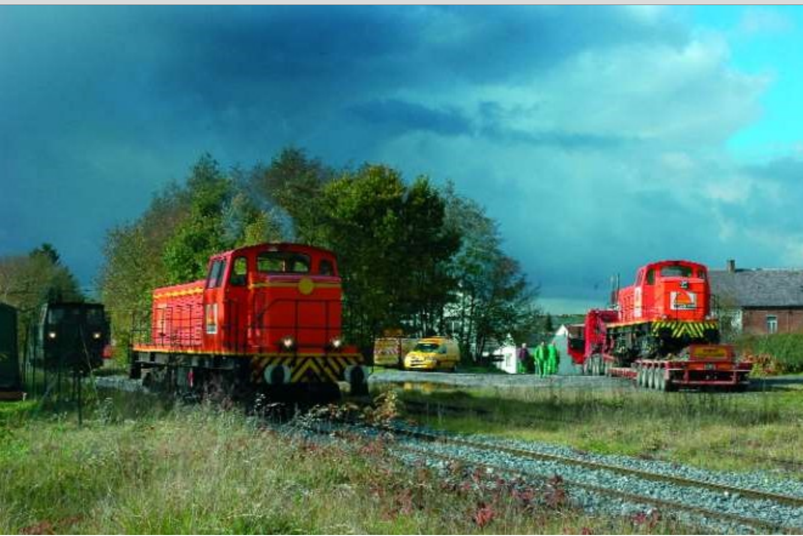
FOTO 83-52 ↑ - FOTO 83-53 ↓ De tweede DE 600 van SECO-rail werd op 30 oktober 2007 per vrachtwagen te Momignies afgeleverd. Ze werd met behulp van twee grote kranen gelost. Het bedrijf "Les Houillères du Nord Pas-de-Calais" bezat 109 machines van dit type. Men nam ze tussen 1958 en 1963 in dienst, ze ontwikkelden een vermogen van 600 pk (825 pk voor 10 machines met aangepaste dieselmotor). Pierre HERBIET.
