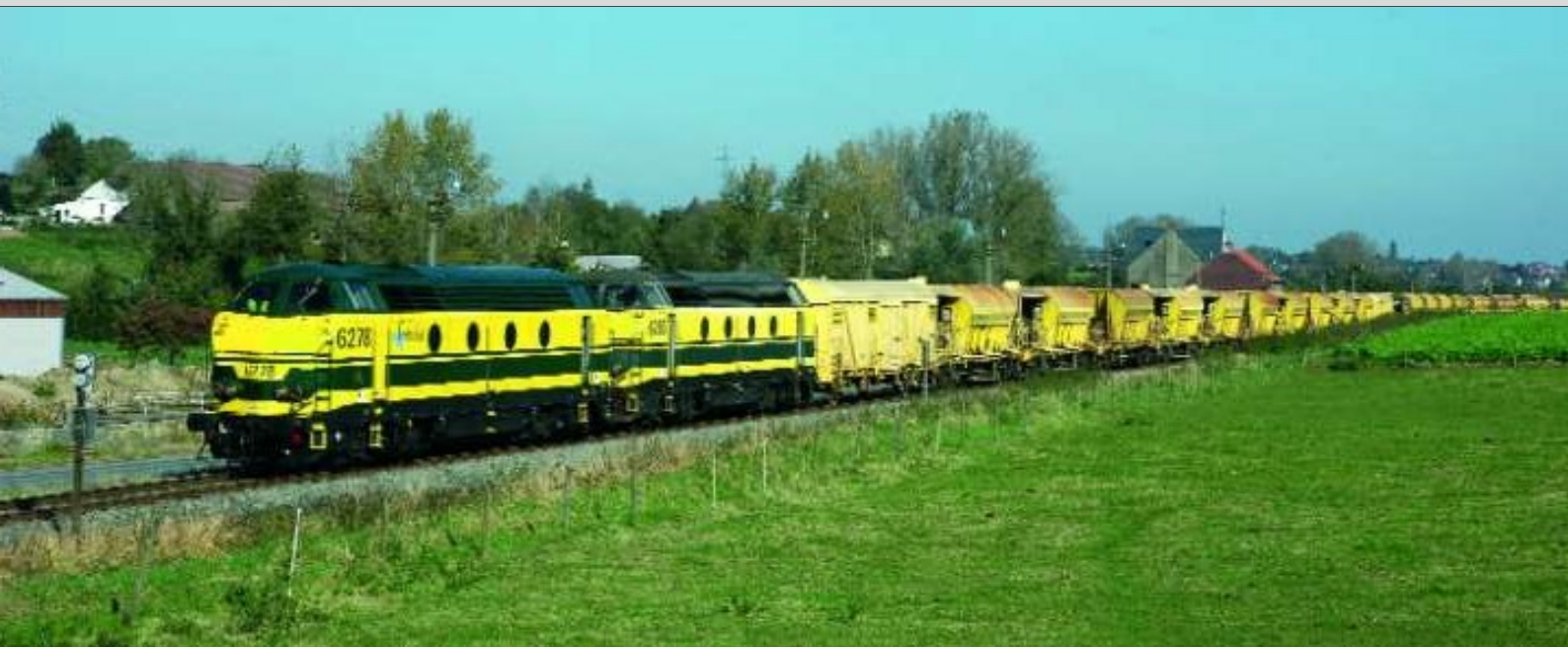
FOTO 83-37 In 2007 heeft Infrabel vier 62'ers gereviseerd en herschilderd: de 6242, 6278, 6304 en 6312. Op 22 oktober 2007 trokken de 6278 en de 6285 een lege ballasttrein op lijn 115 Tubize - Quenast, hier gezien te Ripain. De trein is samengesteld uit speciale wagens van het type Faccns 9820A6 (zie ODB 59 pag. 35) die de ballast kunnen lossen op een naastliggend spoor.
