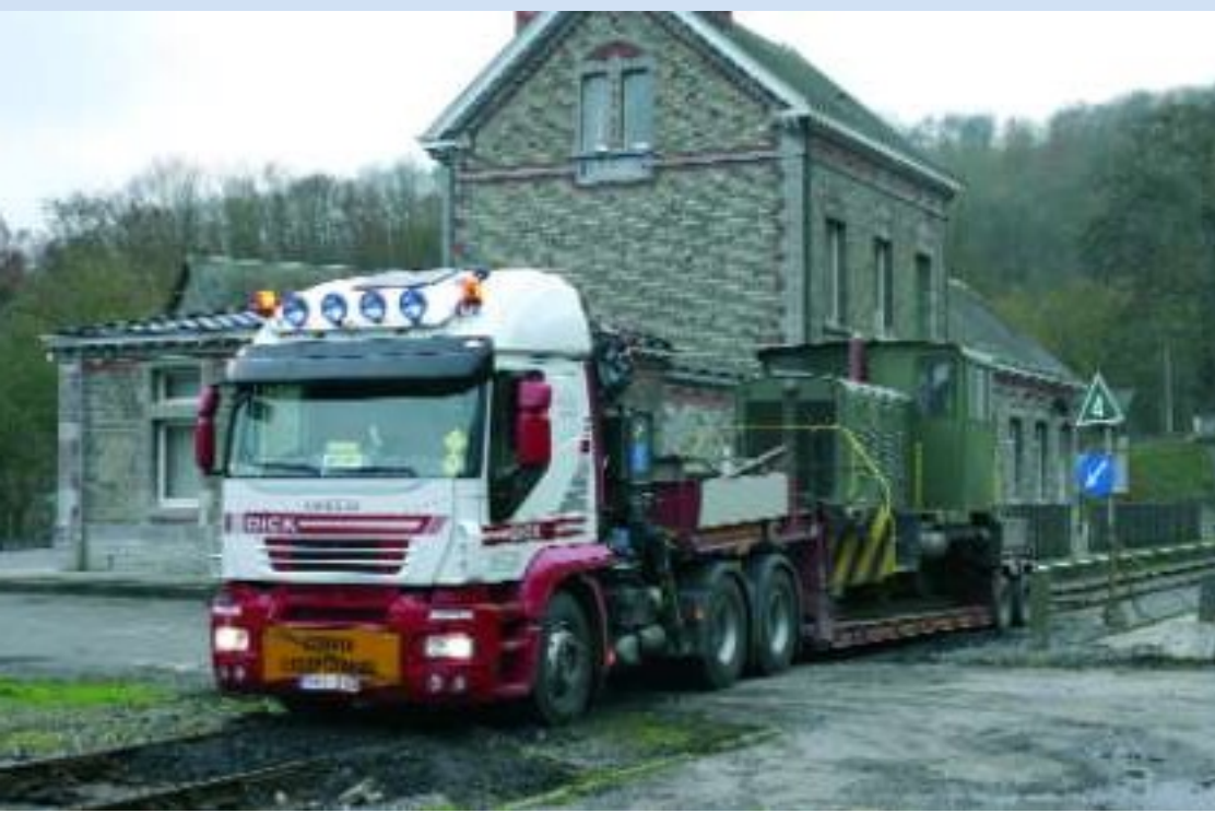
FOTO 83-08 Op 13 november 2007 komt de Cockerill-locotractor aan te Spontin. De vrachtwagen positioneert de dieplader op het spoor om de locomotief te lossen. TSP / Christian AUCQUIERE.
