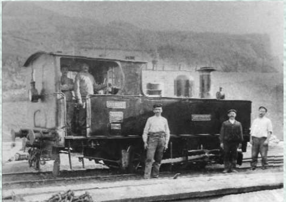
↑ Het tractiepark van de steengroeven was zeer heterogeen. Hier de 2-assige "Germaine", normaalspoor, in 1898 gebouwd voor de groeve van Tacquenier door Les Forges, Usines et Fonderies d'Haine-Saint-Pierre (FUF). Ze was voorzien van twee verschillende koppelingen en twee soorten buffers. Ze werd niet meer gebruikt door de CUP. Verz. Michel DUHAUT.
