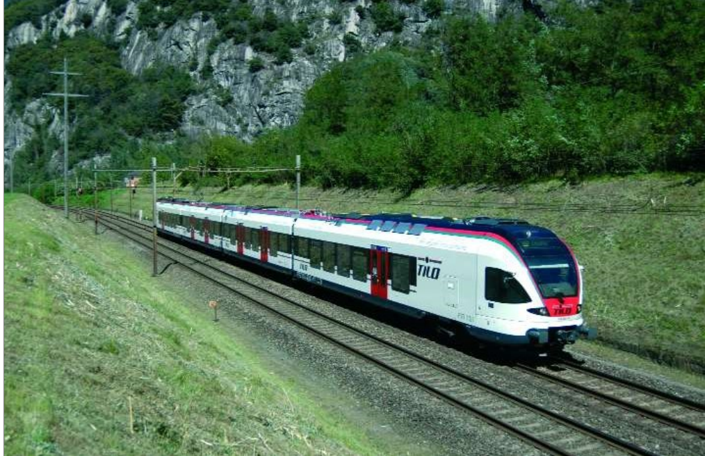
De RABe 524 van de SBB was de eerste tweespannige FLIRT-reeks (3 kV/15 kV). De 30 vierledige eenheden van deze reeks worden door het SBB-filiaal TILO ingezet op de verbindingen tussen Ticino en Milano. Claro, 8 september 2007. Marc STRIFFER.
