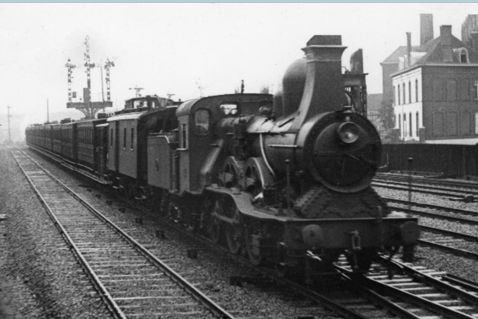
Een trein vanuit Gent via Jette (lijn 50A die nu niet meer bestaat), komt op 24 juni 1911 aan te Brussel-Noord. De trein wordt gesleept door het type 12 nr. 1941 (Cockerill 1658/1891) en is waarschijnlijk samengesteld uit GC-rijtuigen. Het is zeer moeilijk om op dergelijke "zijzicht"-foto's de GC's te onderscheiden van de GCI's. Verzameling TSP..
