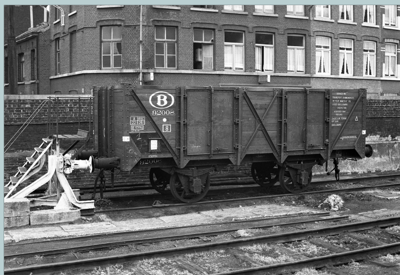
FOTO BD-9801 De dienstwagens kregen ook een nummer uit de reeks 84.001 tot 94.000. Hier zien we stortwagen 92.008 die werd ingezet voor het vervoer van afval. Het gaat om een 'wapenstilstandswagen' die later tot het type 1211A(3) zou gaan behoren. Liège-Guillemins, 2 juli 1962.
