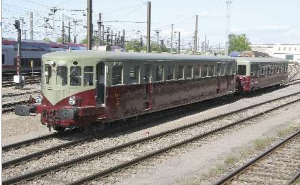
Na haar restauratie zullen de De Dietrich-motorwagen Z105 en zijn bijwagen RZ 1011 vanaf de herfst opnieuw op het CFL-net mogen rijden. De foto werd gemaakt in de werkplaats van Pétange op 22 mei 2010 tijdens de tractieproeven. Christian SCHMIDT.
