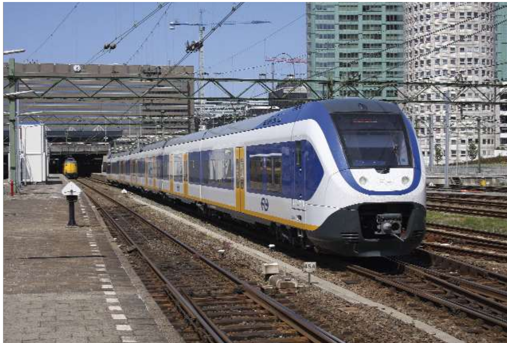
FOTO 98-XX De zesledige uitvoering van de SLT biedt 610 plaatsen (waarvan 322 zitplaatsen) en is 100 m lang. De 2604, geleverd op 9 maart 2009, vertrekt op 3 juni 2010 als Sprinter 9851 vanuit Den Haag CS naar Utrecht. Philippe DE GIETER.
