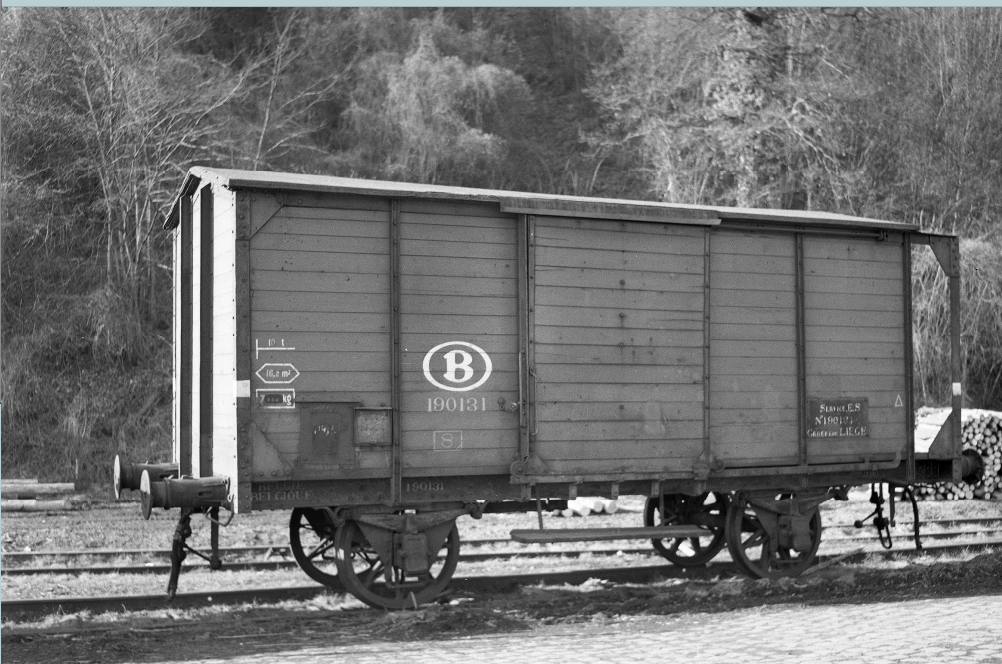
FOTO BD-9802 Door het toenemend aantal voertuigen moesten er in 1907 bijkomende nummerreeksen worden ingevoerd. De dienstwagens kregen de nummers 186.601 tot 194.000. Wagon 190.131, gefotografeerd in Bomal op 15 februari 1959, maakte oorspronkelijk deel uit van een serie van 100 gesloten wagens van 5 ton (nummers 57.001 tot 57.050 en 58.001 tot 58.050) die in 1898 werden gebouwd.
