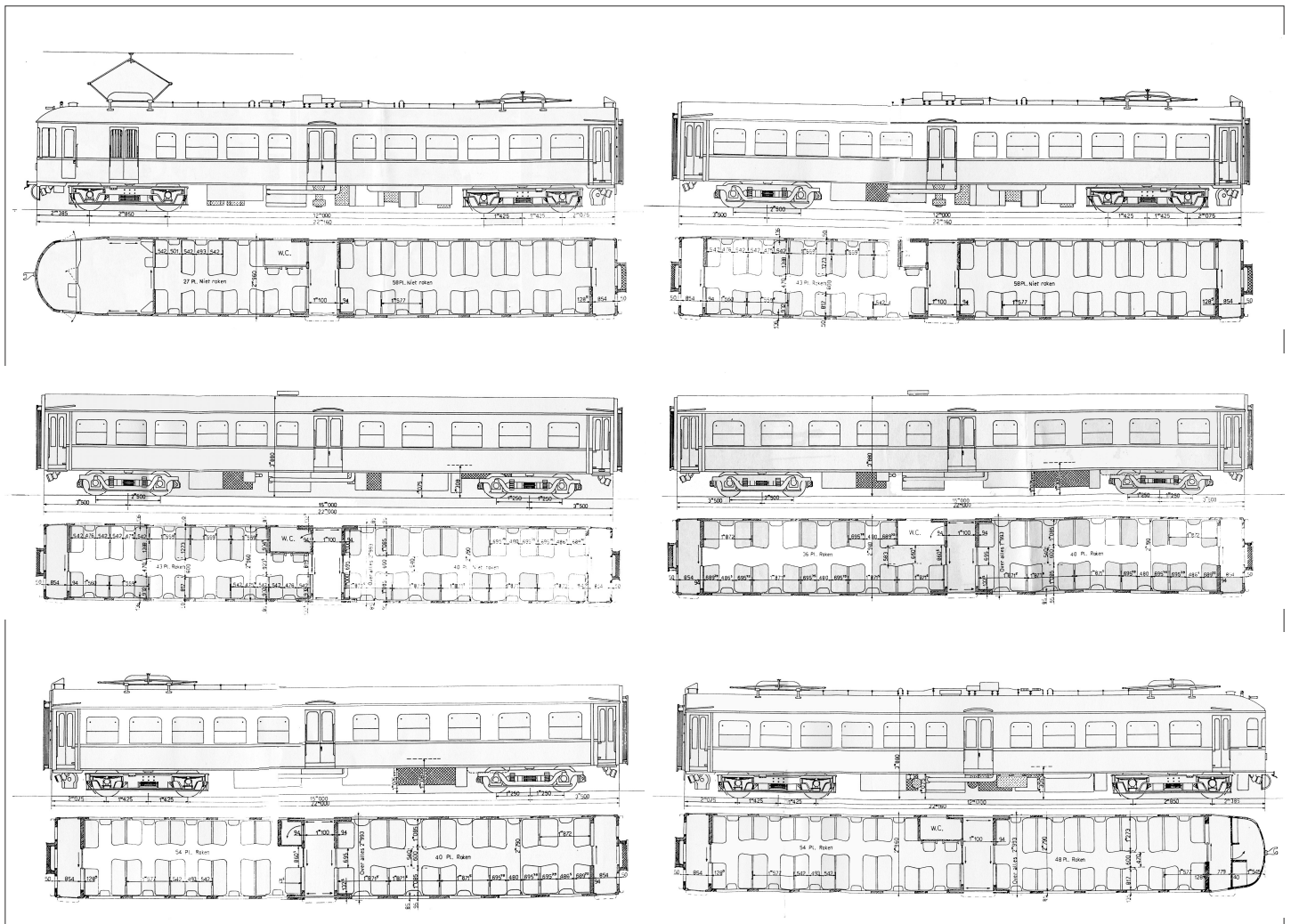
Ziehier een project van Baume & Marpent dat erg lijkt op het definitieve project van de motorstellen uit 1935, maar uitgevoerd met 6 rijtuigen. We merken op dat de rijtuigen 2 en 5 motorbogies dragen en voorzien zijn van een stroomafnemer. Collectie TSP.
