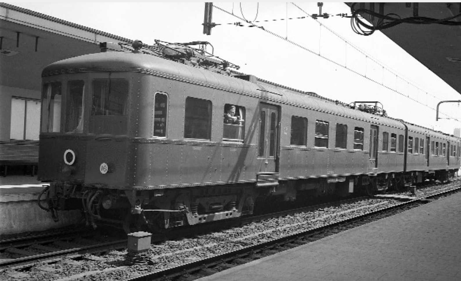
FOTO BD-9904 Het stel 16/228.004 in het station van Brussel-Noord. Het is geschilderd in twee tinten groen met een zwarte band. Let op het enorme draaistel met dubbel chassis. Fotograaf onbekend, verzameling TSP ©.
