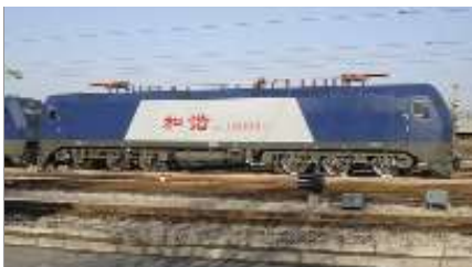
Met zijn 9600 kW is de HXD1B de krachtigste ter wereld met enkelvoudige kast. Van de HXD1B werden 500 eenheden besteld. ZHUZHOU.
