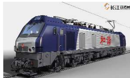
De 500 HXD2B ontwikkelt eveneens 9600 kW. Zij kunnen treinen van 8000 t slepen.. ALSTOM.
