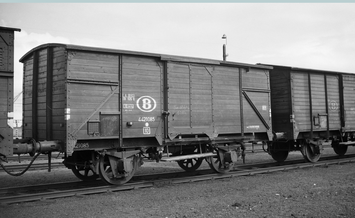
FOTO 99-XX NB Gesloten wagen 4.421.085 in Oostende op 10 april 1958. De eerste drie cijfers geven aan dat het gaat om een gesloten wagen (4) die geremd is (4) van 20 tot minder dan 25 ton (2). Deze wagen van 21 ton, waarvan de kast werd herbouwd, is afkomstig van het "War Departement" (WD). Hij werd ingedeeld bij het type 2000d, later 2000E1. Foto Bruno DEDONCKER, verzameling TSP ©.
