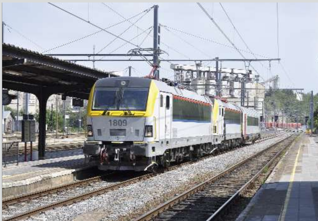
Op 2 juli werden de 1809 en 1810 gekoppeld aan een I11-stuurrijtuig BDx voor een proefrit tussen Kinkempois - Jemelle - Kinkempois. Hierboven de aankomst van de trein te Jemelle. Let op de nieuwe isolatoren in de bovenleiding die reeds voorzien zijn voor de herelektrificatie met 25 kV van de lijn 162 Namur - Arlon. Deze isolatoren werden reeds aangebracht bij de moderniseringswerken van het station die gestart zijn begin 2009. Daniel MOENS.
