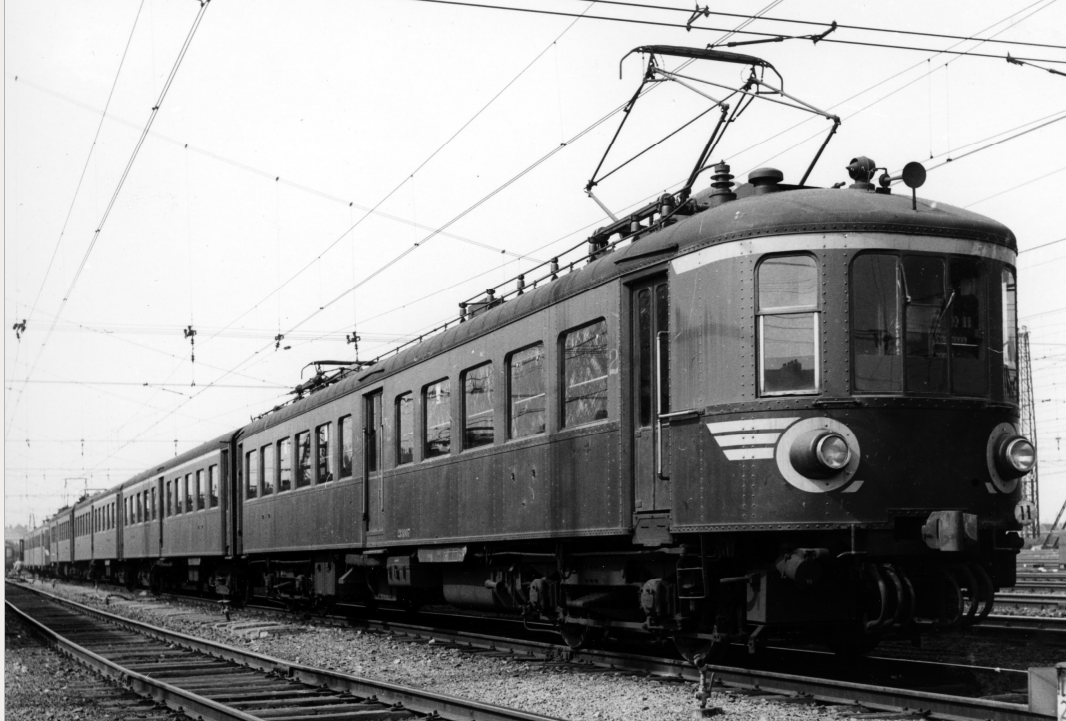
Duidelijk zicht op het stel nr. 11 met op kop het motorrijtuig 213.007 in twee tinten groen, reeds uitgerust met twee koplampen. De datum van deze foto genomen te Brussel Zuid is niet gekend, maar valt te situeren na 1956, aangezien de gele band (1ste klasse) is aangebracht op het tweede rijtuig. Volgens de logica moet het stel het nummer A7 gehad hebben. NMBS-Groep.
