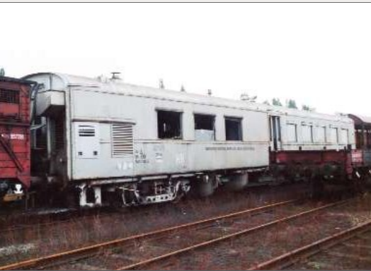
↑ Het buitendienst gestelde rijtuig van de onkruidverdelgingstrein, uitgeweken in Leuven op 19 september 1988. Garrit JOOS.
