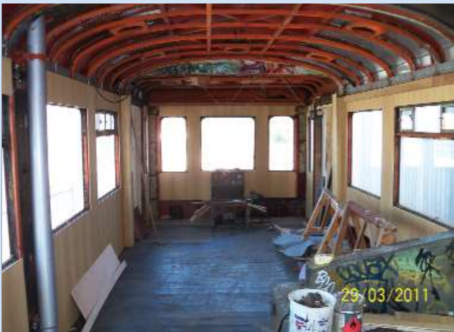
De werken aan de binnenbekleding van de 551.26. TSP / Freddy DELAEBRE.
