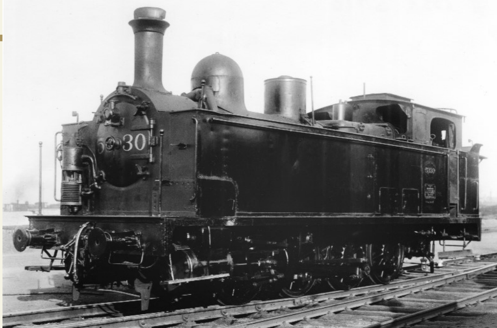
Met de nieuwe indeling per type locomotief, van toepassing op 1 oktober 1931, werden zes types vernummerd (b.v. het type 23 dat het type 53 werd). Hier de 5330 (ex-4830, Gilain 64 / 1914) van het depot Schaarbeek waar het nummer conform werd aangebracht: geschilderd op de rookkastdeur en in een ovaal op de wanden van het machinistenhuis. We bemerken de kleine maar vreemde lantaarn geplaatst op de rookkastdeur. De machine kwam in dienst op 6 mei 1914, buiten dienst in Berchem op 25 april 1960. Foto NMBS groep.
