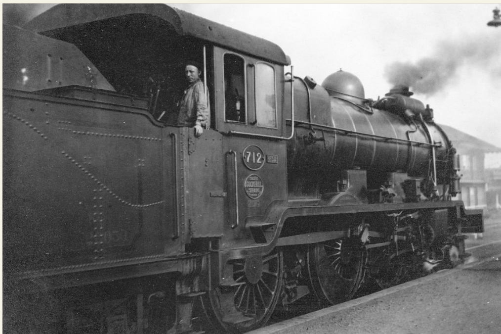
Het type 40 nr. 4031 (ex-4931, ex-ROD 825 - Baldwin 47679 / 1917) in het station van Namur. Ze draagt een ovale plaat, model 1929 van 474 x 304 mm met rode achtergrond. Eronder bevindt zich de eigenaarsplaat: FSU (Baulers). De tenders hadden eveneens ovale platen met daarop hun nummer. Vanaf september 1931 werden deze platen verwijderd en vervangen door een nieuw nummer bestaande uit 4 of 5 cijfers van 100mm hoogte, geschilderd op de zijwanden, 40 mm van de onderste hoeken. De eerste twee cijfers geven de watercapaciteit van de tender weer. In dit geval heeft de tender 21.031 een capaciteit van 21 m 3 . Deze machine werd in december 1964 in Kortrijk geschrapt.
