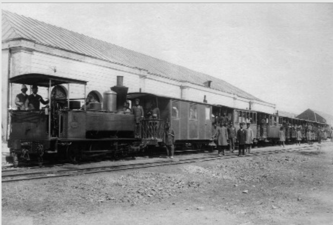
De "Mashin Doodi", gesleept door locomotief 3 (Tubize 664 / 1887). Let op de drie verschillende rijtuigtypes en hun gelijkenis met het buurtspoorwegmaterieel.
