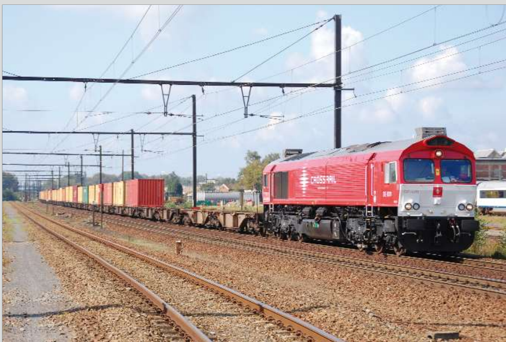
FOTO 106-34 ↑ De DE6311 "Hana" gefotografeerd op 15 september 2011, eveneens in Hasselt, met rechts op de achtergrond de werkplaats. Deze Class 66 kwam op 30 augustus in dienst bij Crossrail. We bemerken op het dak, boven de stuurpost, de airco.
