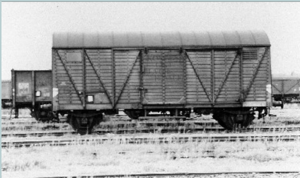
↑ Wagen 4.427.429 (type 2211B), verhuurd aan de K.N.G. & S.F. De "K" van "Koninklijke" werd in 1950 toegevoegd. De foto werd na de vernummering van 1954 gemaakt. Verzameling Charles OCSINBERG.
