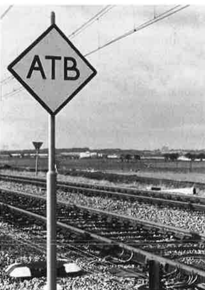
...het inschakelbord ATB. De machinist schakelt bij dit bord de ATB in, indien zijn trein van een ATB-loos baanvak komt.
