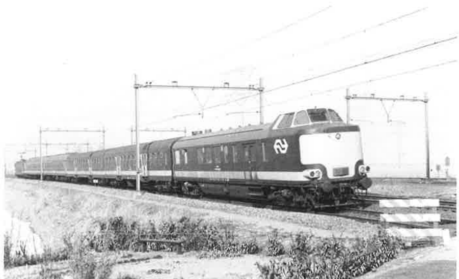
Met het stuurstandrijtuig vooraan gaat het richting Brussel. Teneinde extreem hoge temperaturen in de stuurcabine te voorkomen, werd op dak en raamljsten een laag witte verf aangebracht. Lage Zwaluwe, 24 februari 1986. Foto Ronald Mardaga.
