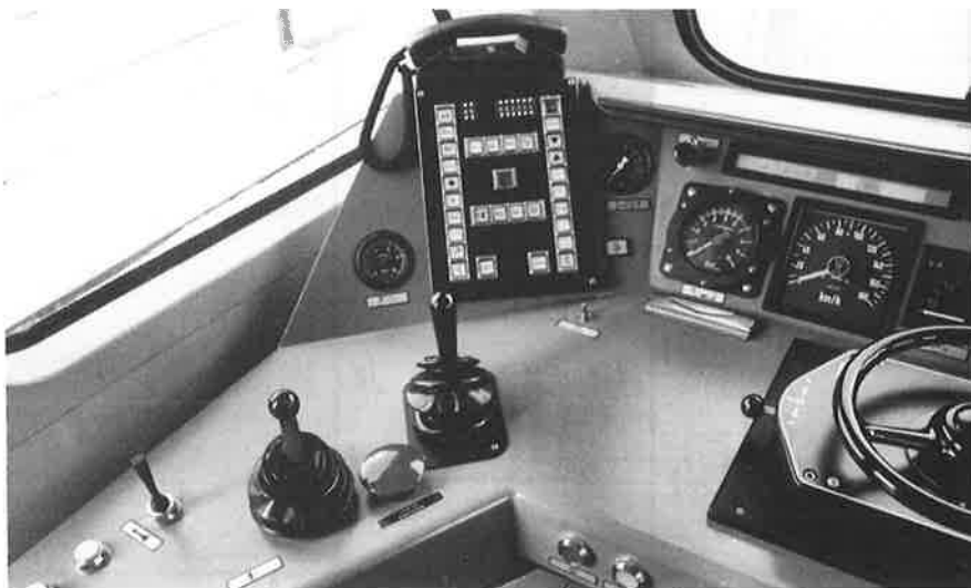
Bij de NMBS 1100-serie is de ATB in de stuurtafel ingebouwd. De lampen zijn boven de snelheidsmeter geplaatst. Bij de remkraan treft u de ATB-kwiteerknop aan.
