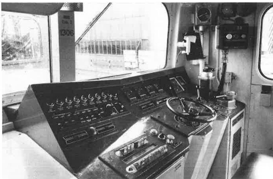
In de stuurstand van de vernieuwde NS 1300 is de ATB-kast boven de remkranen geplaatst.
