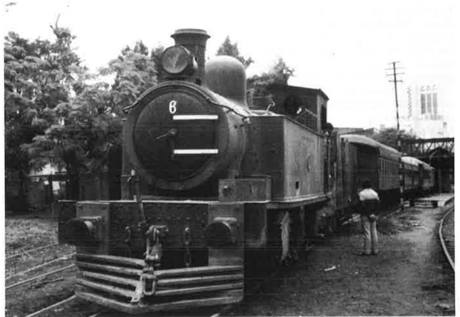
De houtgestookte tenderlok nr. 6 (asindeling 1.3.1, twee buitenliggende cilinders) haalt een reizigerstrein op in het havengebied van Encarnacion. De machine heeft, afgezien van de koevanger, duidelijk Europese allures. De foto werd in 1983 gemaakt door Leo De Smet, een sinds 1948 naar Paraguay uitgeweken Vlaming. (Verzameling Staf Cuyt.)
