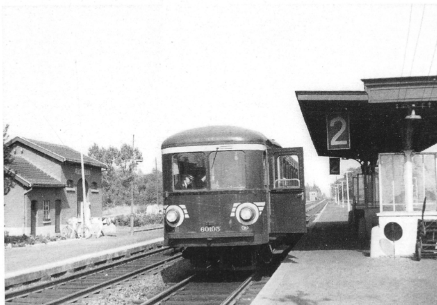
Het fraaie motorrijtuig 601.05 (ex-601.14) uit 1933, door Jacques Bazin gefotografeerd te Faurœulx op 15 september 1959. Het behoorde tot de eerste reeks dieselmotorrijtuigen die door de Belgische industrie werd gebouwd. Verzameling Jan Mahieu.
