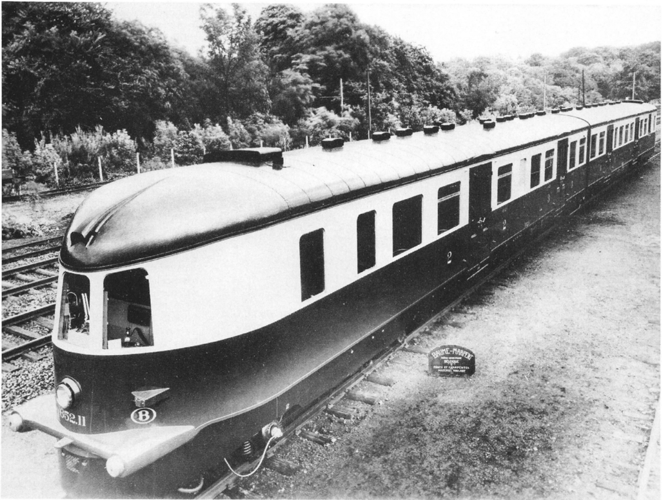
Baume & Marpent fabrieksfoto van tweeledig diesel-mechanisch motorstel 652.11 (later nr. 620.01), vermoedelijk gefotografeerd te Haine-Saint-Pierre. Het stel werd in 1939 gebouwd in het werkhuis te Morlanwelz. Let ook even op de nog net zichtbare elektrische NMVB-tramlijn in de achtergrond. Verzameling Walter Temmerman.
