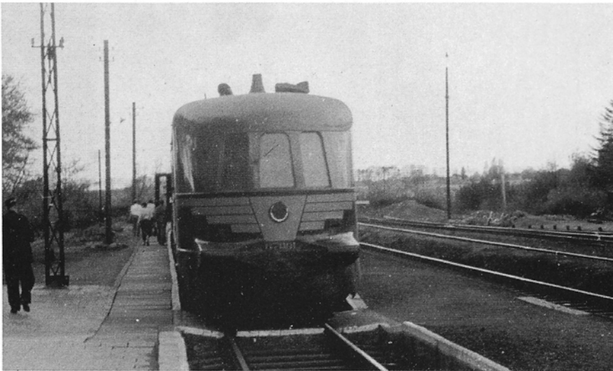
Vooraanzicht van het driedelig diesel-hydraulisch motorstel nr. 670.01, oorspronkelijk het nr. 653.11 uit 1939, op een niet nader bepaalde plaats gefotografeerd nà 1946. Onbekend fotograaf, verzameling Eric Keutgens.
