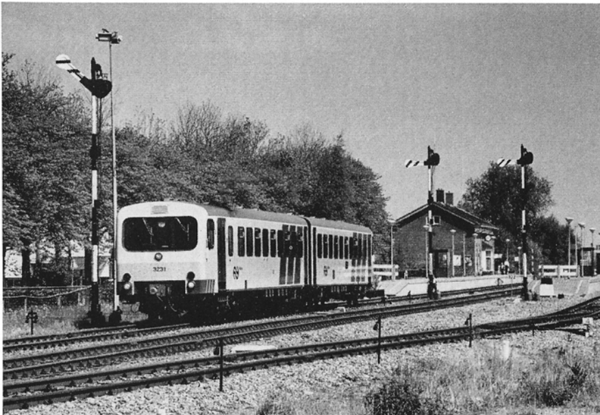
Dieselhydraulisch treinstel 3231 als trein Nieuwe Schans - Groningen bij Zuidbroek in mei 1985. Dit materieeltype bedient alle diesellijnen in de provincies Groningen en Friesland.
