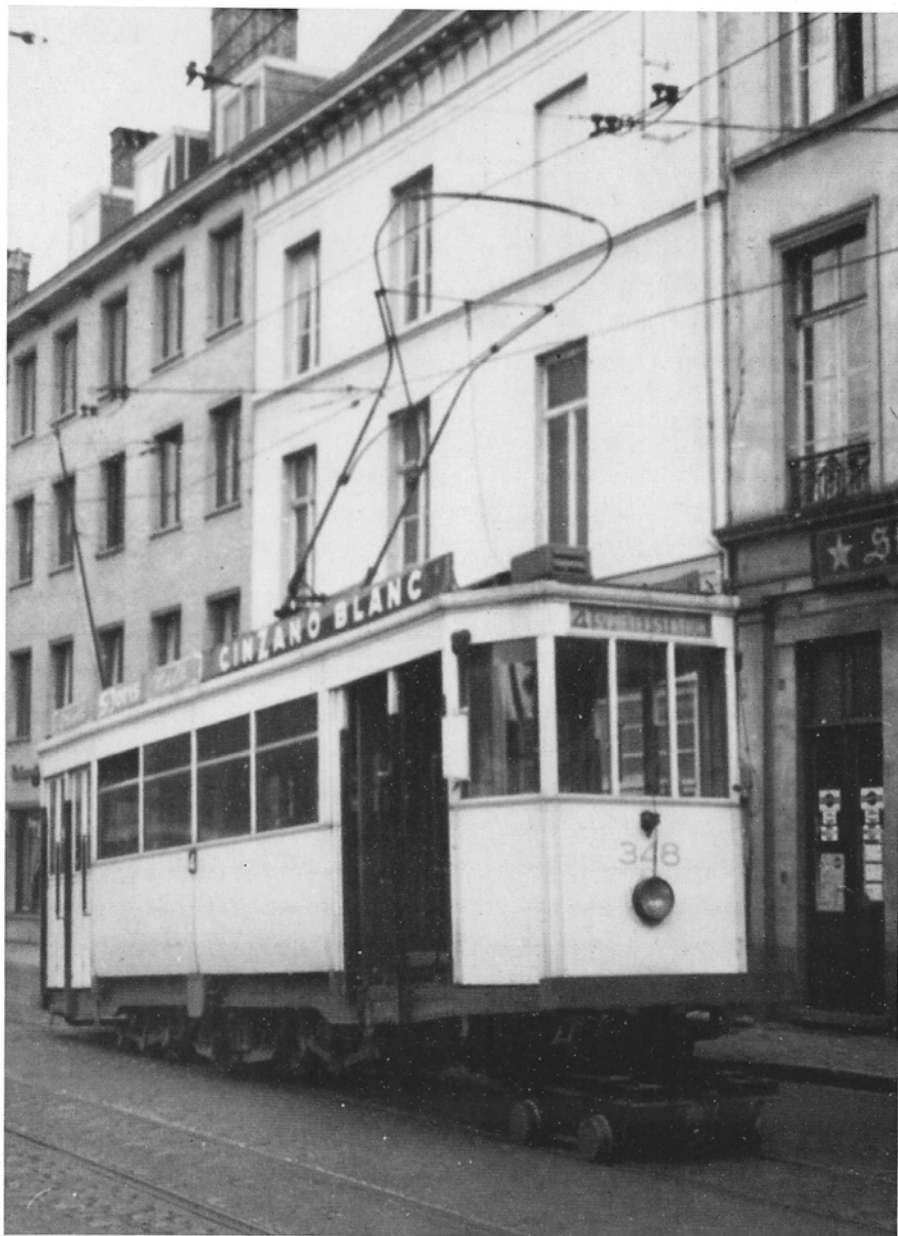
Dankzij de spoorlorry kon een tram met beschadigde as op eigen kracht de stelplaats bereiken. Foto Robert Temmerman, 16 juli 1963.
