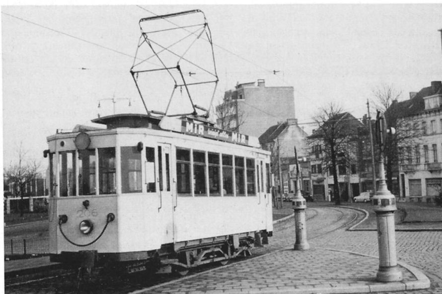
Drie rijtuigen werden uitgerust met zwaardere motoren evenals met Sécheron beremming en pantograaf, dit om bijwagens te kunnen trekken. De 206 zal het langst in dienst blijven. Enkele rijtuigen uit de reeks werden verbouwd met rechthoekige ramen. Onbekend fotograaf (vermoedelijk Edu Bouwman), verzameling Pierre de Meyer.
