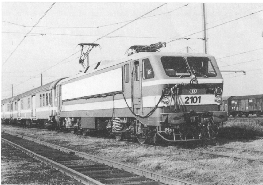
Lokomotief 2101 NMBS tijdens een proefrit te Oostende-Zeehaven op 31.10. 1984. Let op de voor allerlei metingen bestemde bekabeling opzij van de machine (Foto J. Mahieu)
