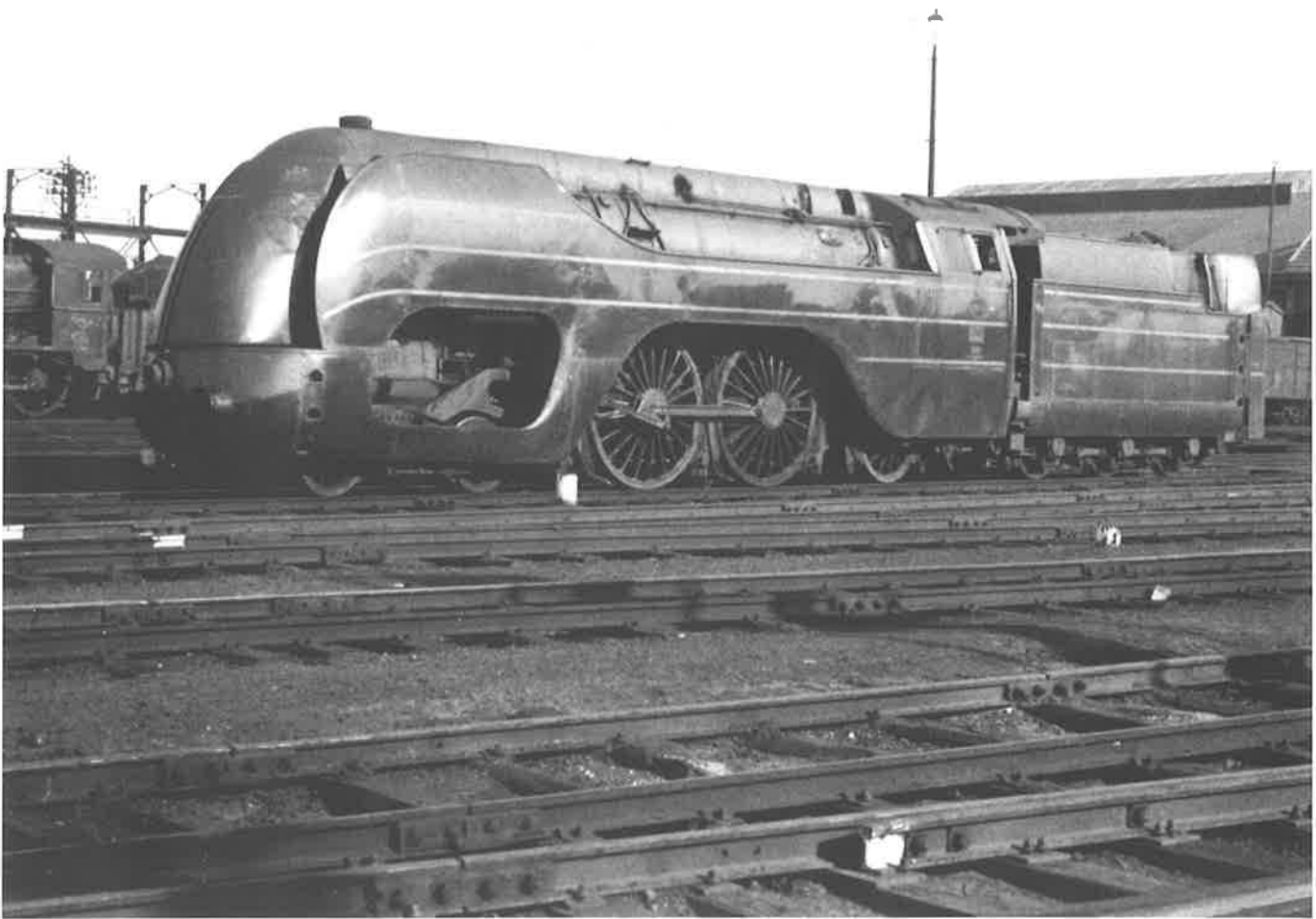
De 1204 tijdens de tweede Wereldoorlog te Leuven. Let op de koplamp-afscherming. (Foto K.J. Harder)
