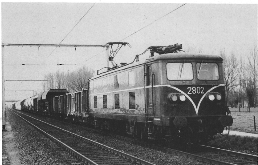
Bij het verschijnen van de 7.000 pk-machines van de nieuwe reeks 20 (2001-2025) diende, in de eerste helft van de jaren zeventig, het reeksnummer in „28” te worden gewijzigd. De oude Acec-pantografen werden door dito Faively's vervangen. 2802 met een gemengde goederentrein te Erembodegem op 16 maart 1981. Foto Ronald Mardaga.
