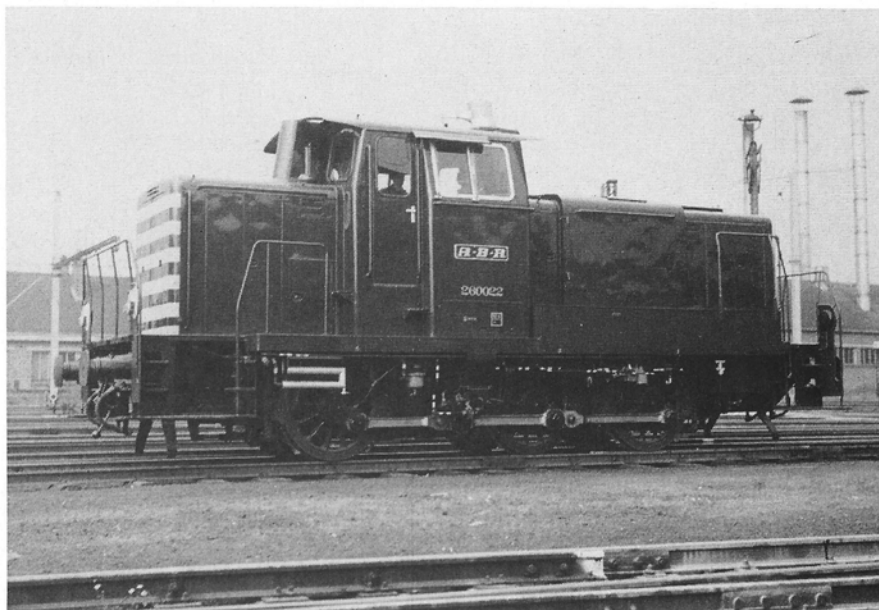
De rangeerdieseltjes type 260 vervingen de rangeerstomers van de types 53, 58 en 98. De foto toont de eerste door ABR Familleureux aan de NMBS afgeleverde machine 260.022. Later werd het type 260 de reeks 80, terwijl de Duitse zuster machines V 60 werden ondergebracht in de DB-reeks... 260! Schaarbeek vorming, 1961. Foto NMBS.
