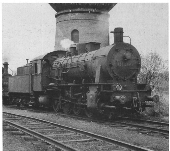
Lokomotieven 81.107 en 81.266 in het depot van Monceau, september 1964. Let op de geheel verschillende rookkastdeuren en op het open tweede venster in het machinistenhuis (zie de tekst van het artikel). Foto's Roger Belot.
