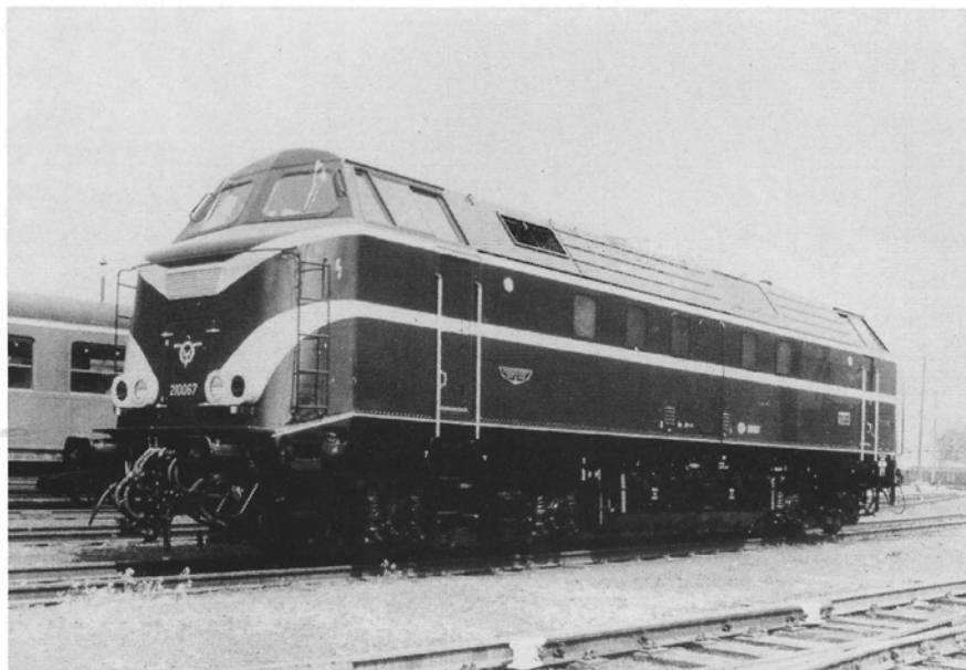
210.067 (1) (later 210.201/6101) toont op het front een symbool, erop wijzend dat deze machine met een elektronische vermogensregeling is uitgerust. Foto NMBS.
