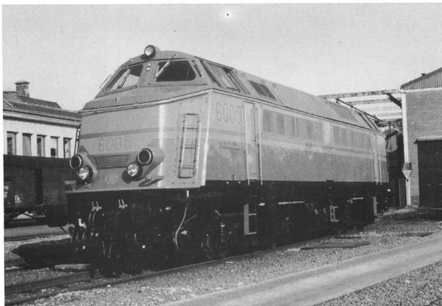
6005, in blauw-gele uitmontering te Salzinnes op 15 maart 1982, was de enige lokomotief uit de reeks 60/61 die treinen elektrisch kon verwarmen. Foto Jan Mahieu.
