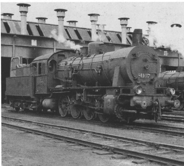
Lokomotieven 81.107 en 81.266 in het depot van Monceau, september 1964. Let op de geheel verschillende rookkastdeuren en op het open tweede venster in het machinistenhuis (zie de tekst van het artikel). Foto's Roger Belot.
