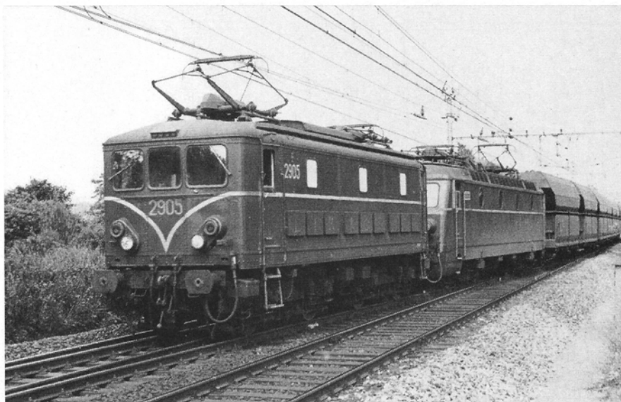
2905 + 2233 aan kop van een ertstrein te St.-Genesius-Rode op 13 mei 1980. Door de sterke hellingen in het Waalse landsgedeelte is het noodzakelijk om een tweede lokomotief bij te plaatsen. Deze opstelling, waarbij de 29 vooraan stond, kon men als het ware een „standaard” noemen. Er werd ook gereden, zij het in mindere mate, met een lokomotief uit de reeksen 23, 25 en soms zelfs 26. Foto Ronald Mardaga.
