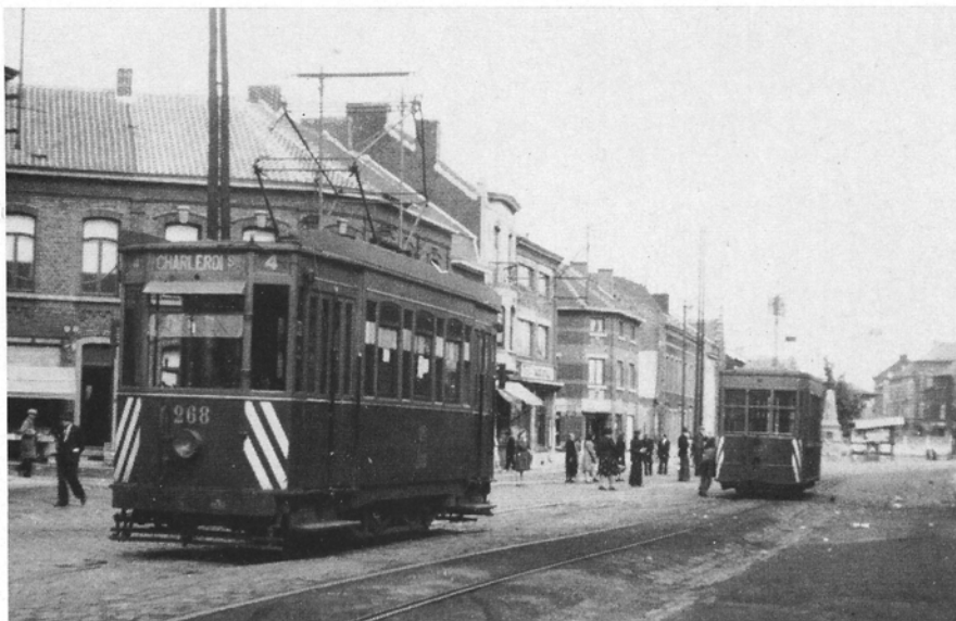
Motorrijtuig 268 en „Anversoise“-bijwagen in de voor de Duitse bezettingstijd typische verduisterings-livrei. Dit beeld ontstond hoogst waarschijnlijk kort na de oorlog, vermits de koplamp van het rijtuig niet (meer) „afgeschermd“ is. Foto N.N. Forbes, verzameling Jean de Meurs.
