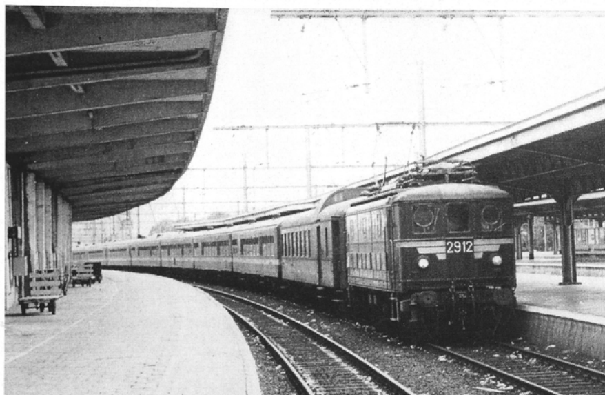
2912, met enkele koplampen en „verdwenen” trapezium, brengt een sleep reizigersrijtuigen - één type K BD en een aantal type M4 - aan het perron in het station van Oostende op 9 september 1980. Foto Ronald Mardaga.
