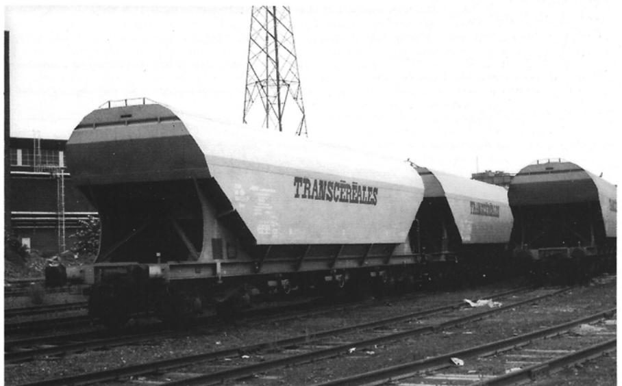
Voor het bulk-vervoer van granen wordt gebruik gemaakt van speciale wagens van het type „zelflosser”. Meestal zijn dit privé-wagens en namen als Cita en Transcéréales zijn op dit gebied zeker geen onbekenden.
