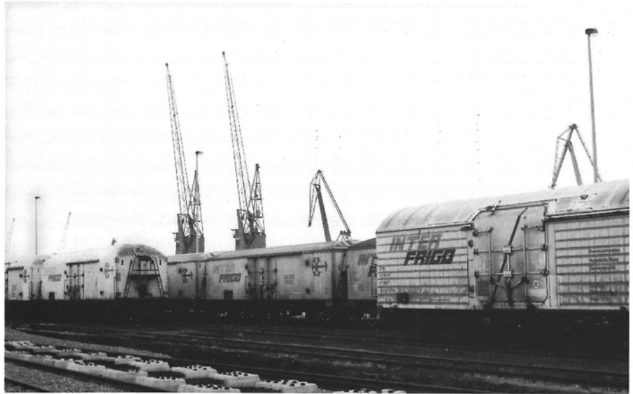
Bij frigowagens kan men drie grote groepen onderscheiden : de isothermwagen, de koelwagen en de machinekoelwagen, waarin aan bederf onderhevige goederen worden vervoerd onder „gecontroleerde temperatuur”.
