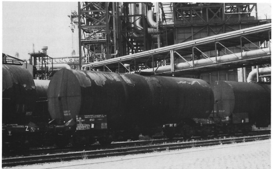
Speciale ketelwagens met warmte-isolering zijn nodig voor het vervoer van extra-zware stookolie (pitch).
