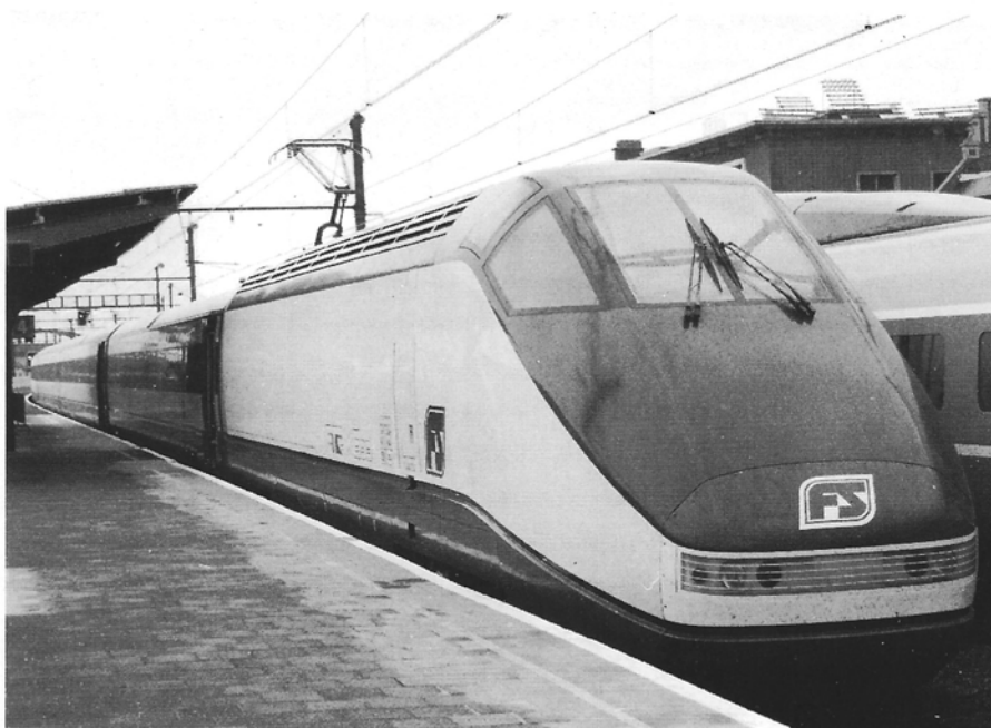
In tegenstelling tot de andere elektrische hogesnelheidsstellen kan de ETR500 van de Italiaanse Spoorwegen bij ons rechtstreeks via de bovenleiding worden gevoed. Bij de FS is immers een gedeelte van het net geëlektrificeerd onder 3000 V gelijkstroom. Het ontwerp van het stel werd ondermeer toevertrouwd aan Pininfarina, een bekende naam in de autowereld. Schaarbeek, 25 april 1992, foto Willy Henderikx.
