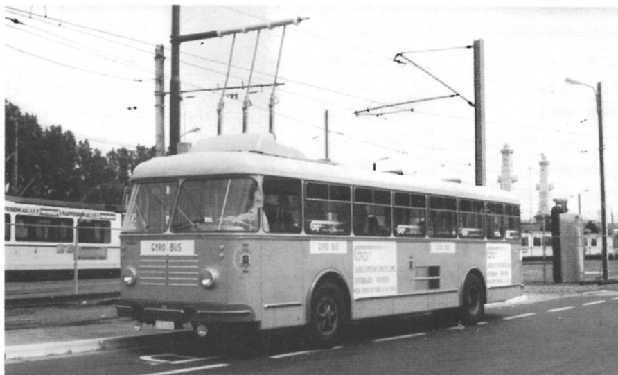
Oostende, Brandariskaai, 1 augustus 1985. Gyrobus G3 werd voor het Jaar van het Openbaar Vervoer gerestaureerd en opnieuw, als evenement, in Oostende in dienst gesteld. De G3 staat hier aan een voedingsmast. Foto Eric Keutgens.
