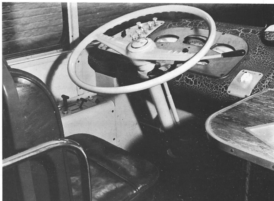
De stuurpost van een gyrobus. Foto Roels, archief Keutgens.
