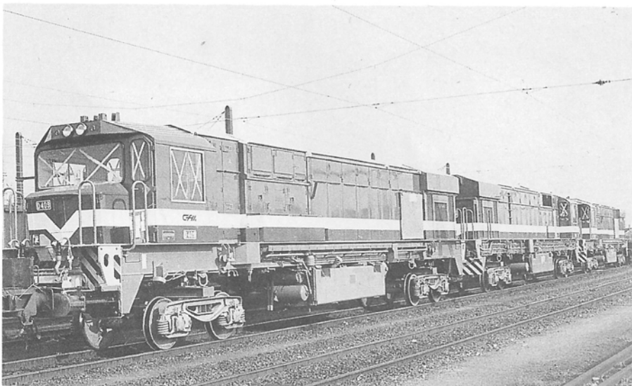
Voor verschepping naar Mozambique komen smalspoor-diesellokomotieven uit Frankrijk via Stockem per spoor naar Antwerpen. Op de foto zien we zeer duidelijk dat voor vervoer op normaalspoor „noodbogies” en „tijdelijke buffers” worden gemontereerd. Antwerpen Schijnpoort, 27 mei 1992. Foto Willy Henderikx.
