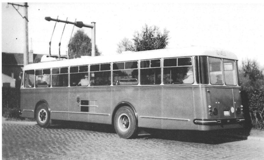
De drie antennes zijn nu tegen de voedingsmast gedrukt : de G2 neemt stroom af. Foto Jacques Cohn.
