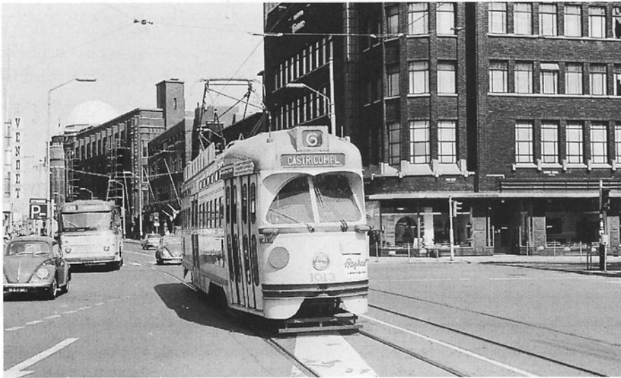
De op drie stuks na geheel gesloopte vervolgsérie 1003-1024 behield haar typische PCC-gedaante doch kreeg meteen drie deuren met een gewijzigde raamindeling. Rijtuig 1013, nog zonder bel naast de lijnfilmkast, op lijn 6 aan de Grote Markt (t.h.v. de Prinsengracht) op weg naar het Castricumplein. 30 mei 1966, foto Roger Bastaens.
