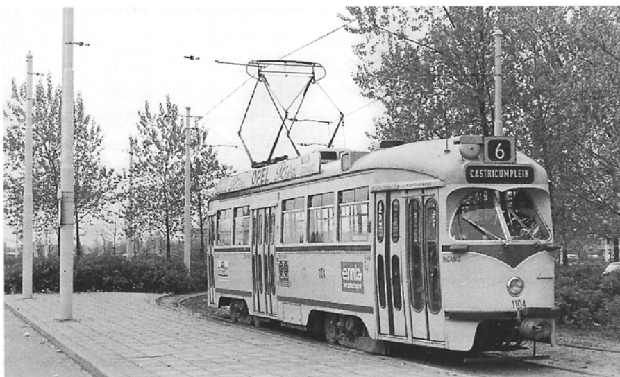
Ook op lijn 6, aan het Mariahoeveplein : PCC 1104 uit de honderd stuks tellende reeks 1101-1200 heeft een Scharfenberg-koppeling en, eigenaardig, vóóran twee verschillende deurtypes ! 21 april 1974, foto Roger Bastaens.
