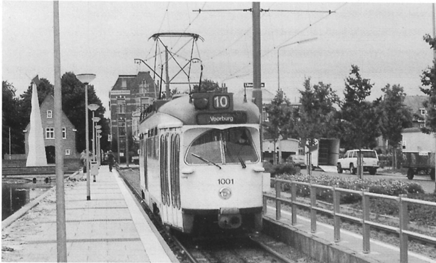
PCC-motorrijtuig 1001 (ex-199, bouwjaar 1949), na grondige verbouwing en modernisering. Dit nu nog bestaand rijtuig is de oudste in West-Europa verblijvende PCC-car. Eindpunt Voorburg, 27 mei 1990. Foto Hans Meyer.
