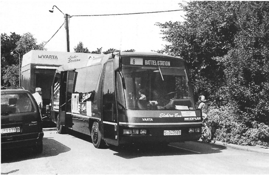
Battel, 13 augustus 1993. De elektro-citybus aan het laadstation voor de verwisseling van de batterijen. Op die dag werd voor elke rit Battel - Mechelen Centrum - Battel telkens van batterijen gewisseld. Foto Eric Keutgens.
