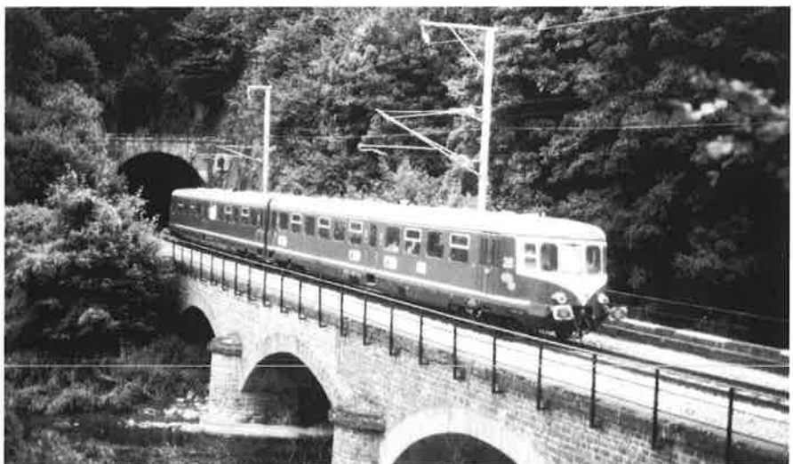
Nog in 1993 reden de door „Westwaggon” in 1956 gebouwde dieseltreinstelletjes uit de reeks 201-208 de lokale CFL-treinen tussen Luxemburg en Troisvierges. Stel 201(-211 ?) overschrijdt in Goebelsmuehle de Sûre en duikt in de tunnel, richting Ettelbruck. De bovenleiding was toen (juli 1993) nog niet „gebruiksklaar”.
