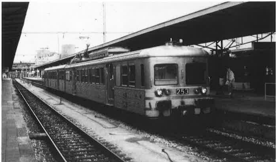
Luxembourg station, 2 mei 1988 : „Carel & Fouché” leverden in 1975 aan de CFL de elektrische stellingen 251-256. De gedeeltelijk geribde plaatbekleding doet eventjes denken aan de NMBS-„Budd”-stellen.
