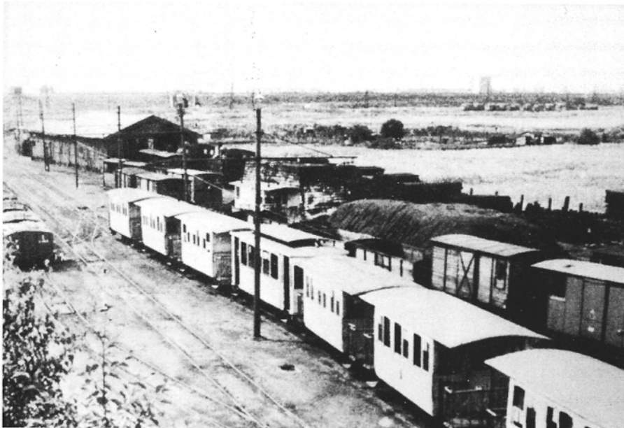
NMVB-stelplaats IJskelder, Merksem, vermoedelijk kort na de tweede wereldoorlog. De tweeassige stoomtram-bijwagentjes met open balkons, waarvan er op de foto vijf in hun geheel te zien zijn, werden tijdens de bezetting ook in de elektrische reizigersdienst ingezet. Foto Frans Keutgens.
