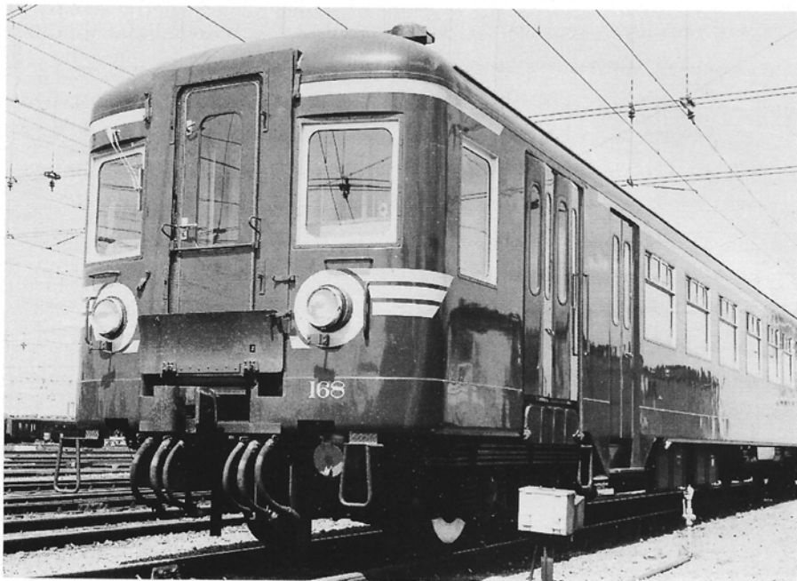
„Close-up” van het AB-rijtuig van motorstel 168. Bemerkt de karakteristieke versiering rond de (enkele) koplampen. De stellingen zijn uitgerust met een half-automatische koppeling. Op de foto zien we de „Atlas-Henricot”-koppeling in haar oorspronkelijk uitzicht. Rechts naast de kleine klauw bevindt zich de ontkoppelhandel. Om spontane ontkoppelingen tijdens de rit te vermijden werden later veiligheidsgrendels aangebracht. Foto NMBS.
