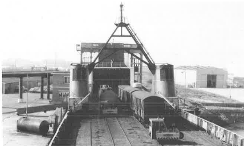
...waar ze door „Trackmobiles” worden overgenomen om op het spoordek te worden opgesteld...
